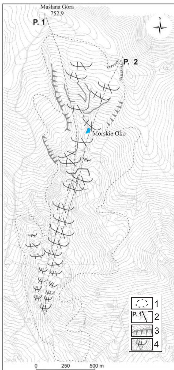
Fig. 2. Szkic osuwiska Sawickiego wraz z położeniem przekrojów obliczeniowych: 1 – zasięg starej (holoceńskiej) formy osuwiskowej, 2 – linie przekrojów obliczeniowych, 3 – zachowane nisze osuwiska, 4 – koluwia osuwiska odnowionego w 1913 r.
