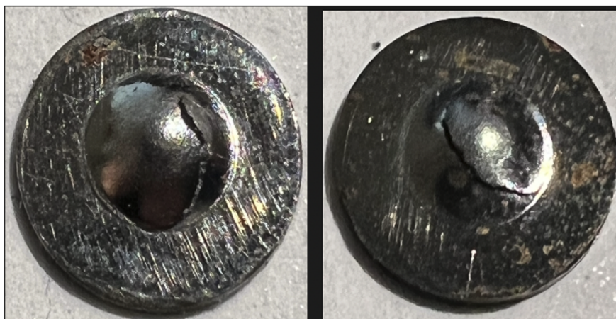
Rysunek 4.15: Próbki J1 DBTT: -160C po lewej; -165C po prawej.
