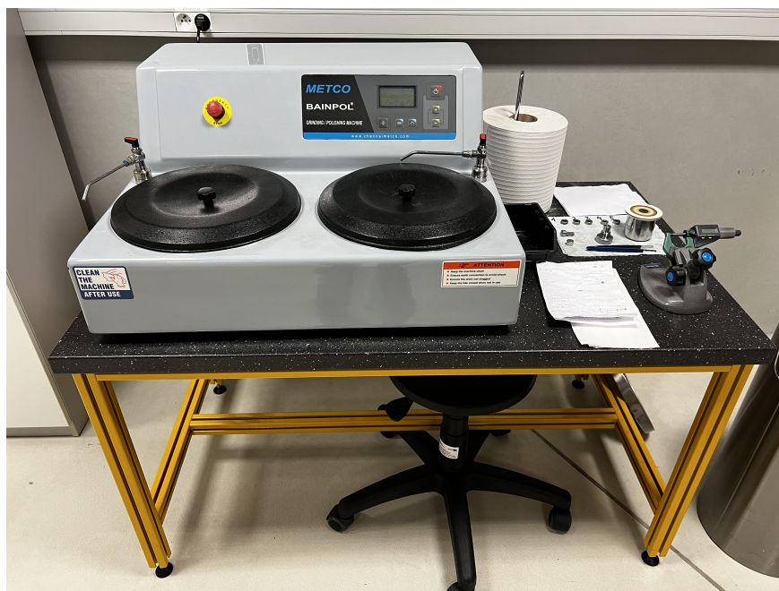
Rysunek 3.7: Szlifierka laboratoryjna
