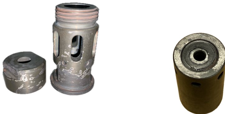
Rysunek 3.14: Kartridż na próbkę do badania SPCT
