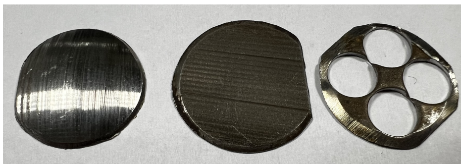
Rysunek 3.6: Próbką materiału w kolejnych etapach przygotowania: a) lezka pobrana z materiału bazowego; b) płaski plaster wycięty z lezki; c) pozostałość materiału po wybiciu próbek SPT na prasie.
