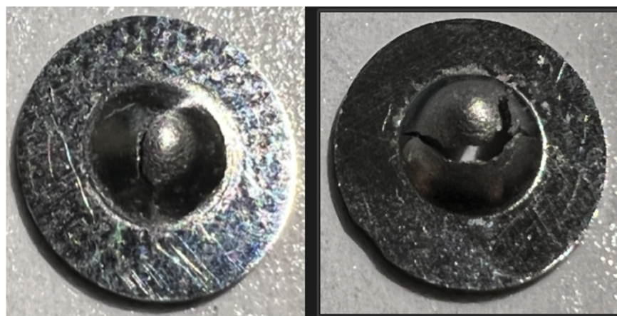
Rysunek 4.16: Próbki D1 DBTT: -175C po lewej; -170C po prawej.
