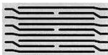
Rys. 4.7. Schemat dwustopniowego połączenia taśm [34]
