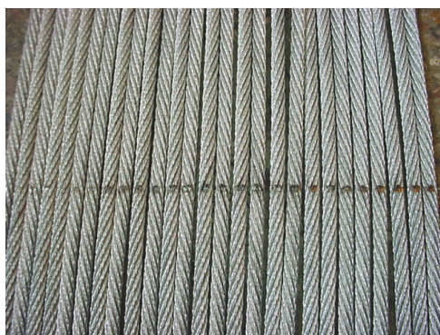
Rys. 8.19. Widok uszkodzenia 19 – starcie szlifierką tarczową na całej szerokości taśmy
