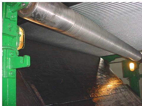
Rys. 8.27. Wulkanizacja linek stalowych w gumie (w warunkach przemysłowych)
