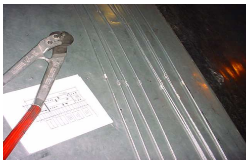
Rys. 8.21. Rozmieszczenie modeli poszczególnych uszkodzeń wg schematu
