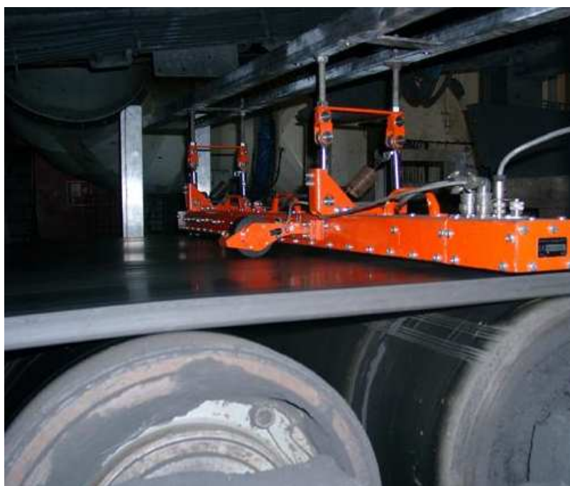
Rys. 4.16. System Introcon po zamontowaniu na przenośniku taśmowym [30]
