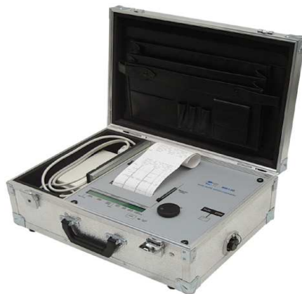
Rys. 5.12. Widok rejestratora MD120 firmy Zawada NDT [36]
