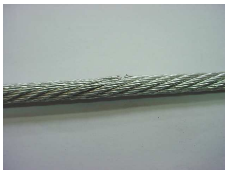
Rys. 8.10. Widok uszkodzenia 2 – pęknięta splotka (7 drutów)
