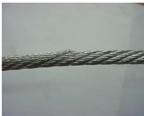
Rys. 8.11. Widok uszkodzenia 3 – pęknięcie 4 drutów
