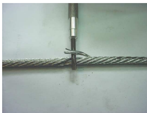
Rys. 9.13. Uszkodzenie 5 – pęknięcie 7 drutów na powierzchni linki
