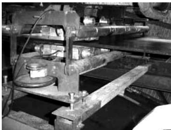
Rys. 5.9. Badanie linek stalowych taśmy przenośnikowej (głowica GP9)
