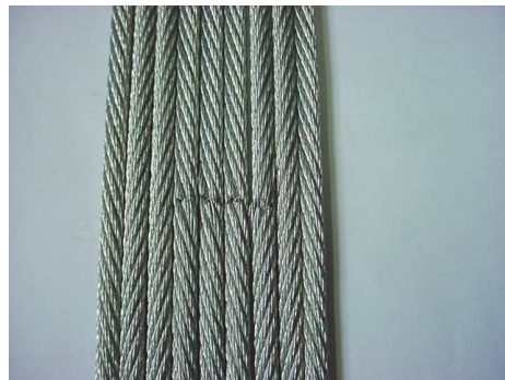
Rys. 8.16. Widok uszkodzenia 10 – pęknięte 4 sąsiednie splotki
