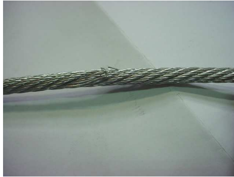
Rys. 8.14. Widok uszkodzenia 6 – pęknięcie 14 drutów na powierzchni linki
