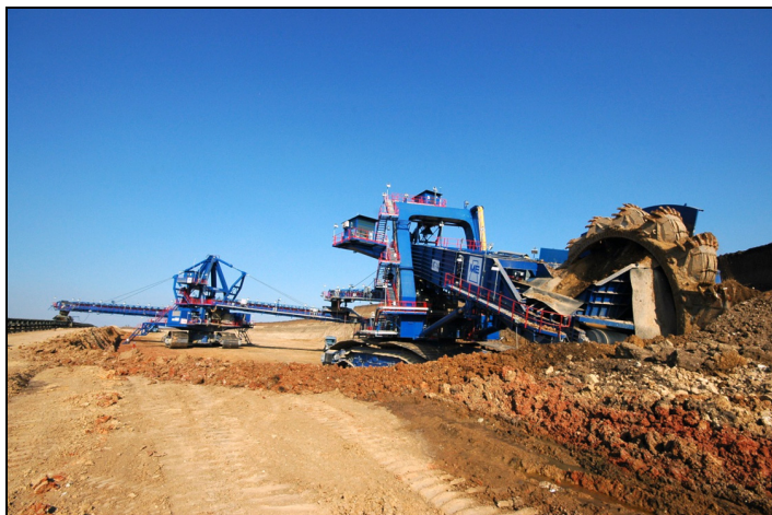
Rys. 2. Koparka kompaktowa PE100-1600/1,5 × 20 razem ze przenośnikiem samojezdnym pracująca w kopalni węgla brunatnego na Węgrzech. Producent SANDVIK (fot. Kasztelewicz 2009)
