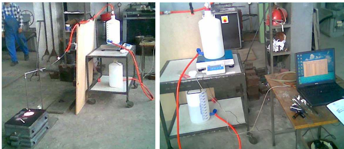
Rys. 105. Zmodyfikowany układ do pomiaru gazotwórczości mas formierskich i rdzeniowych
