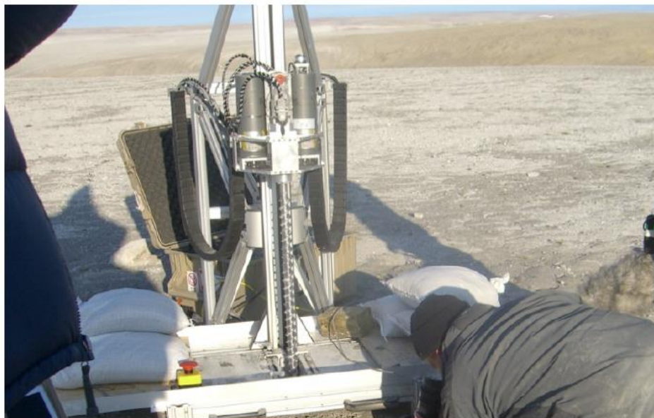
RYSUNEK 33. Testy obrotowo-udarowe urządzenia CRUX w polowych warunkach analogowych (Glass, et al., 2010)
