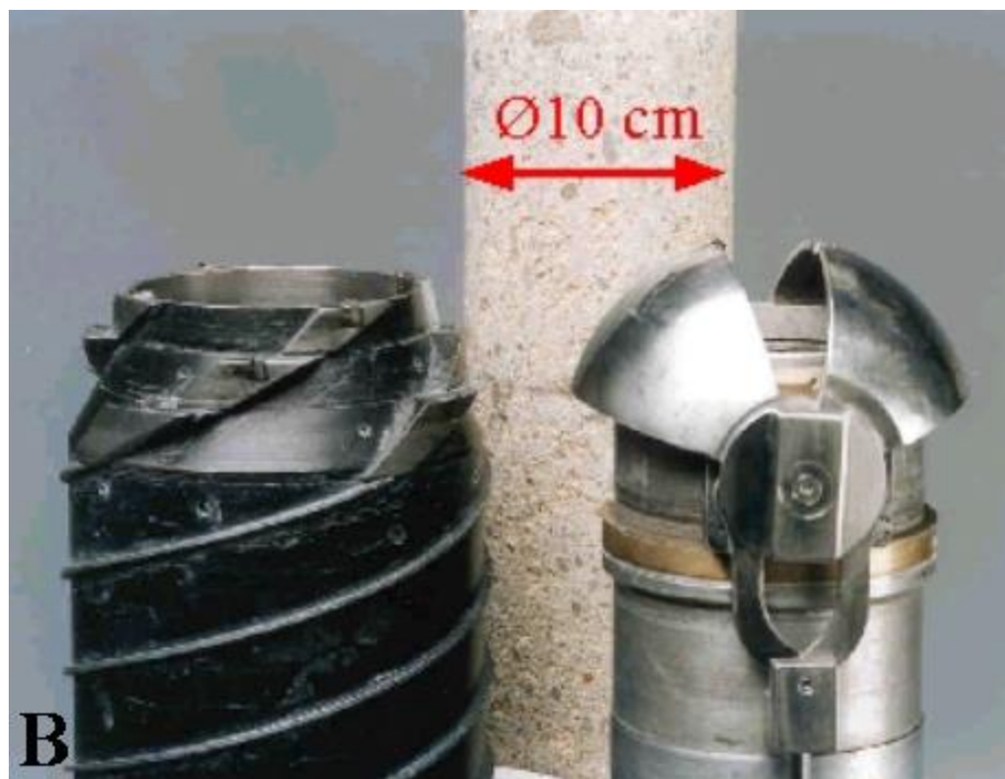
RYSUNEK 28. Rozmontowana koronkowa część urządzenia SAS-1m. Od lewej: rdzeniówka z koronką, rdzeń piroklastyczny, wewnętrzna rura z mechanizmem ścinającym (ESA, 2014).
