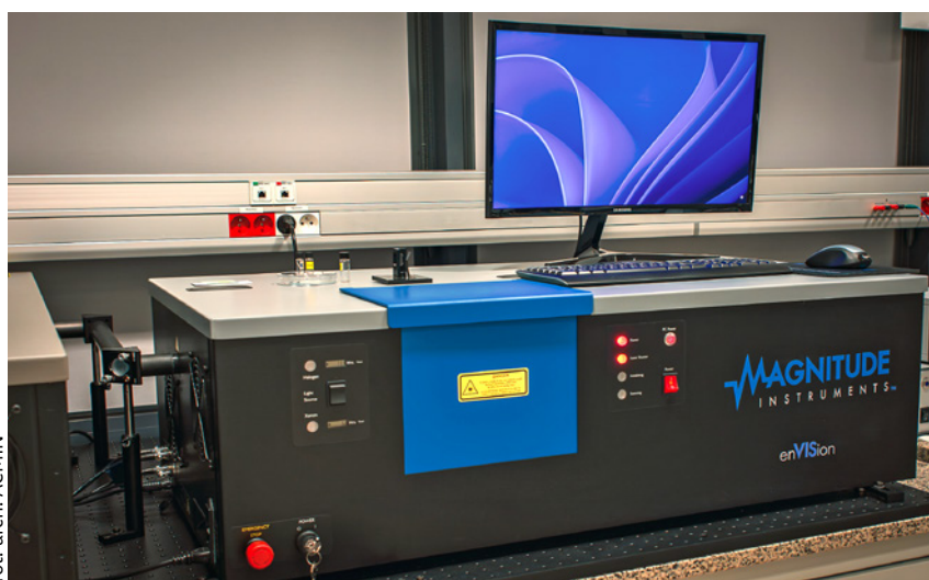
fot. 2. Układ do ultraszybkiej spektroskopii stanów wzbudzonych pozwalający na pomiary szerokopasmowej nanosekundowej spektroskopii absorpcji przejściowej w zakresie ultrafioletu, widzialnym i bliskiej podczerwieni
