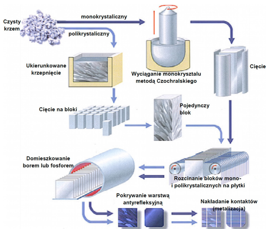
Rys. 39. Proces wytwarzania mono- oraz polikrystalicznych fotowoltaicznych ogniw krzemowych
