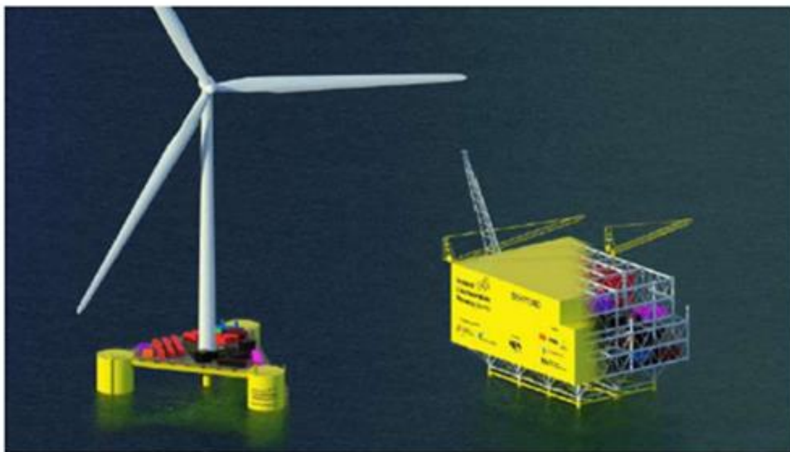
Rysunek 2.31. Różnice w budowie systemu zdecentralizowanej produkcji wodoru na morzu (po lewej), a produkcji na scentralizowanej platformie morskiej (po prawej). Źródło: (Baardsen Høines, 2022).
