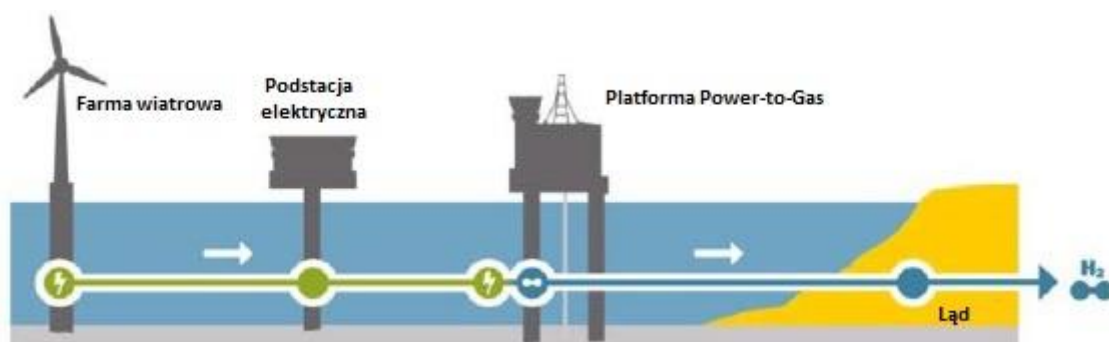
Rysunek 2.4. Schemat morskiego systemu Power-to-Gas na istniejącej platformie wiertniczej. Źródło: opracowanie własne na podstawie (Peters i in., 2020).
