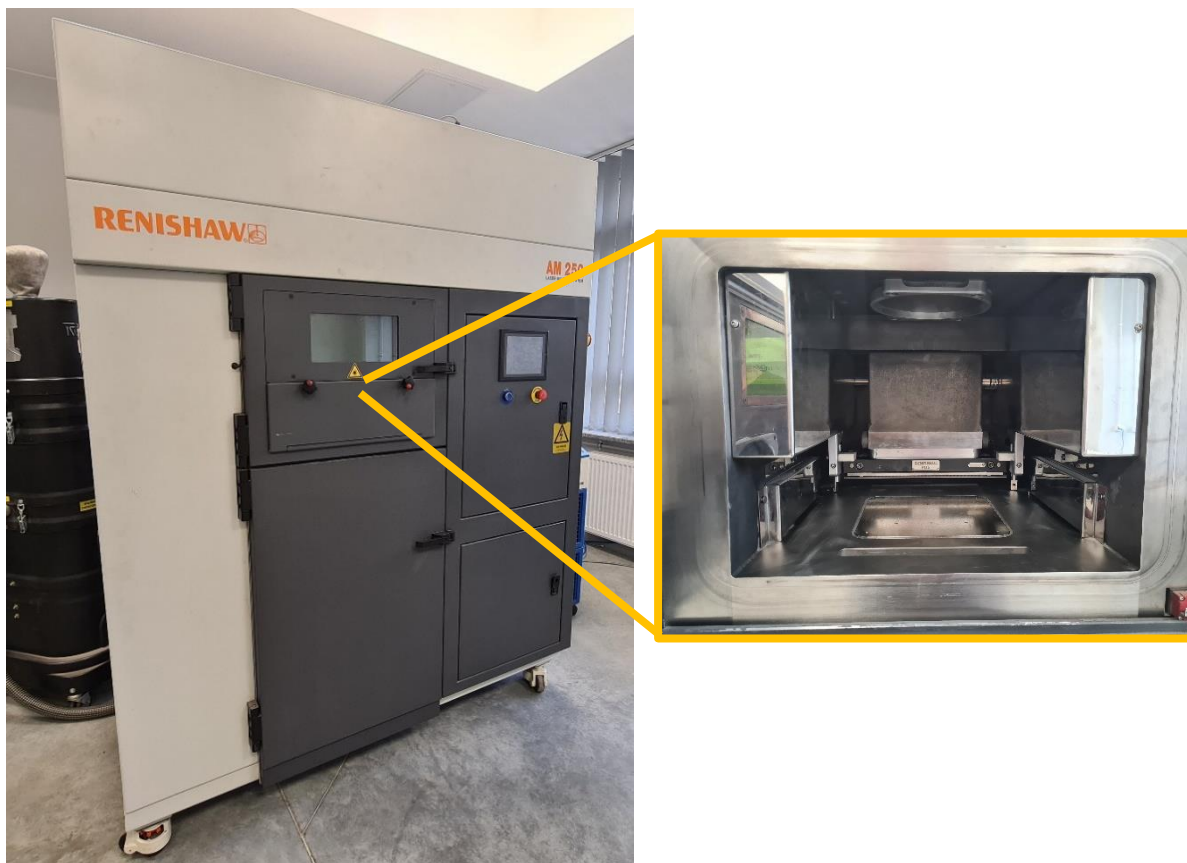
Rys.13. Maszyna do spiekania Selective Laser Sintering/Melting (AM250 – Renishaw) z komorą spiekania
