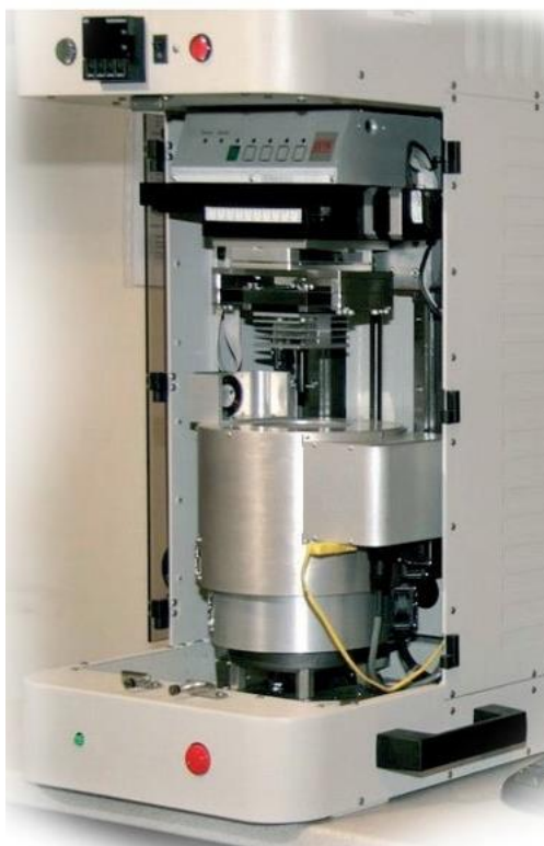
Rys.40. Uniwersalny tester do badań tribologicznych UMT-2MT (CETR, obecnie Bruker)
