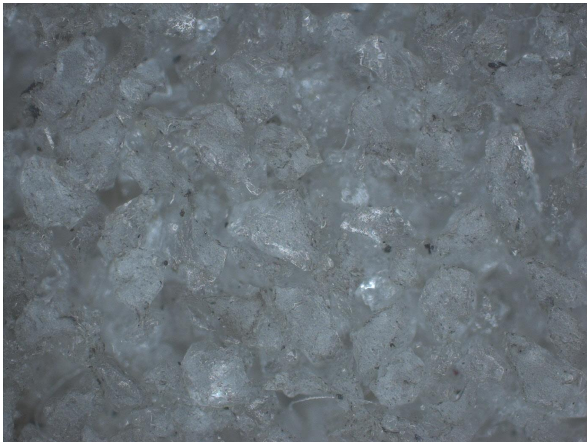
Rys.26. Zdjęcie powierzchni próbki \text{Al}_2\text{O}_3 (prod. Washington Mills) wykonane mikroskopem świetlnym AxioObserver Z1m, powiększenie 50x.
