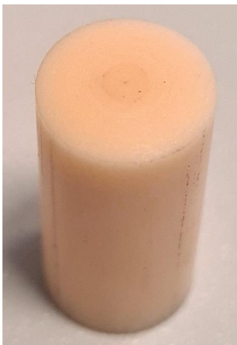
Rys.38. Trzpień \text{Al}_2\text{O}_3 wykorzystany do testów tribologicznych
