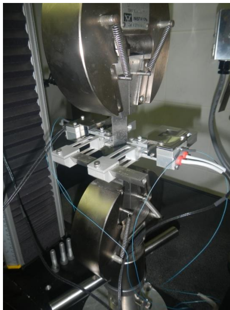
Rys. 5.3. Pomiar wydłużenia w zakresie sprężystym na maszynie wytrzymałościowej Instron 5566, przy użyciu ekstensometru dwuosiowego
