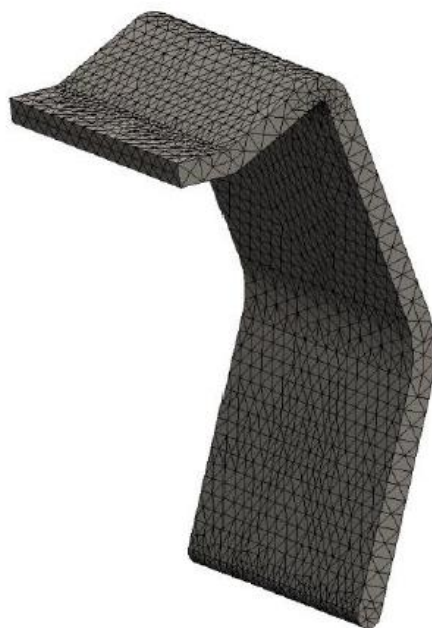
Rys. 6.93. Element sprężynujący (1/2) z naniesioną siatką elementów skończonych
