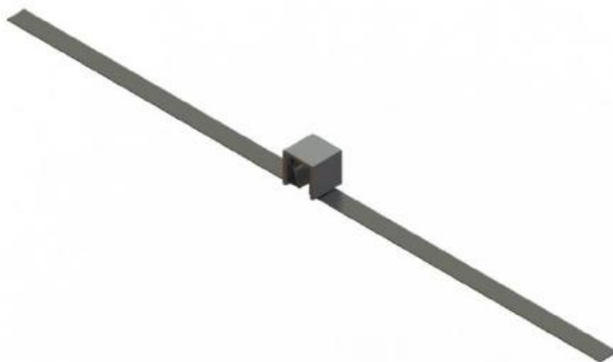
Rys. 6.106. Przestrzenny model numeryczny układu mocującego pasek blachy z zastosowaniem symetrii (widok ogólny)
