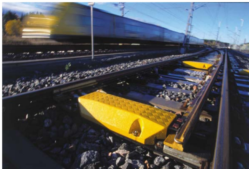
Rys. 6. Zintegrowany napęd zwrotnicowy EBI Switch 2000 zabudowany w rozjeździe [84].
