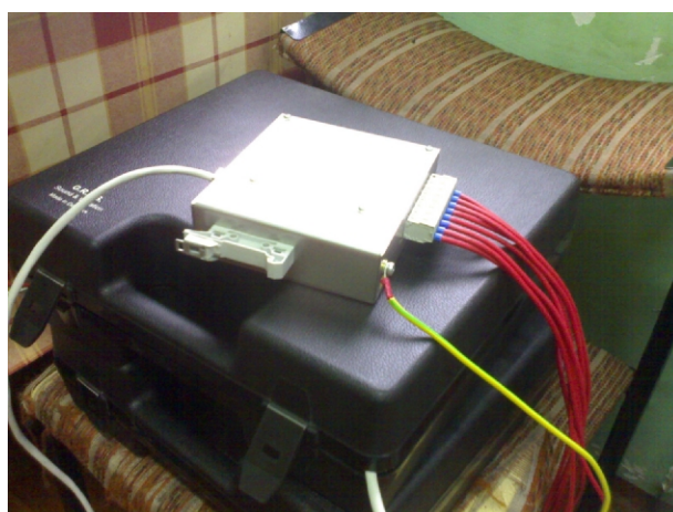
Rys. 86. Podłączenie modułu pomiarowego w nastawni stacji Kobiór
