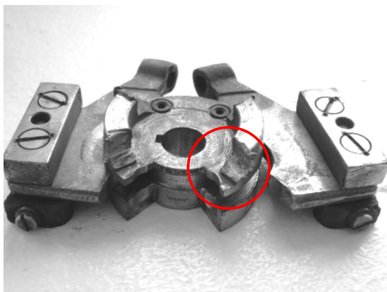
Rys. 44. Zużycia elementów hamulca zatrzymowego napędu EEA-4
