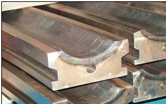
Rys. 6. Łoże kulowe po hartowaniu indukcyjnym
