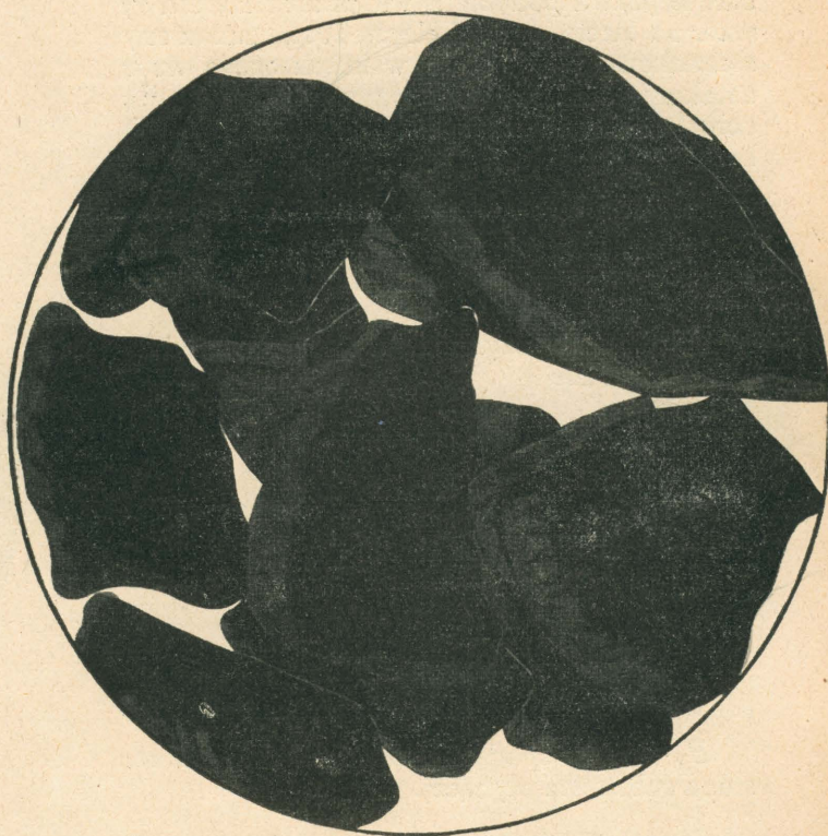
Rys. 5. Wygląd pojedynczej warstwy węgla „Orzech II“, o wielkości kawałków 20-60 mm (wielk. rzeczywista),
