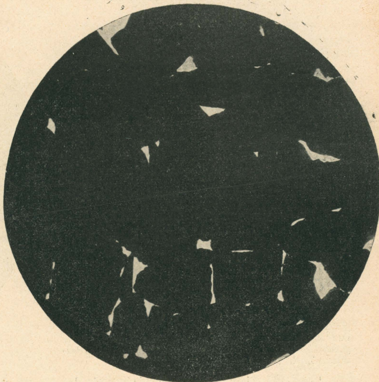
Rys. 6. Prześwity w pojedynczej warstwie węgla „groch“, o wielkości kawałków 10-20 mm (wielk. rzeczy.)
