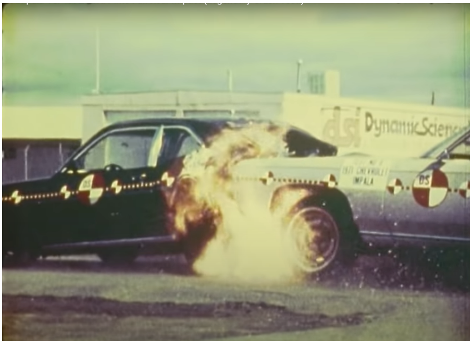
Rysunek 2.1: Test zderzeniowy NCAP 32 - Ford Pinto. Kolidacja w tył samochodu powoduje eksplozję paliwa. Kadr z filmu [30].
