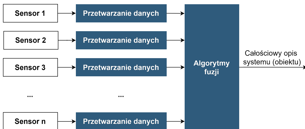
Rysunek 5.1: Podstawowa zasada działania fuzji danych. Sensory dostarczają dane, które są przetwarzane i łączone w zunifikowane wyjście. Inspirowane [145].
