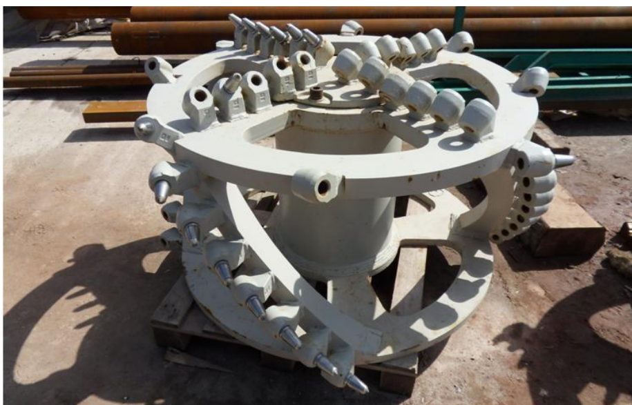
Rys. 4.3. Organ przestrzenny do urabiania utworów solnych w szybie SW-4 [70]
