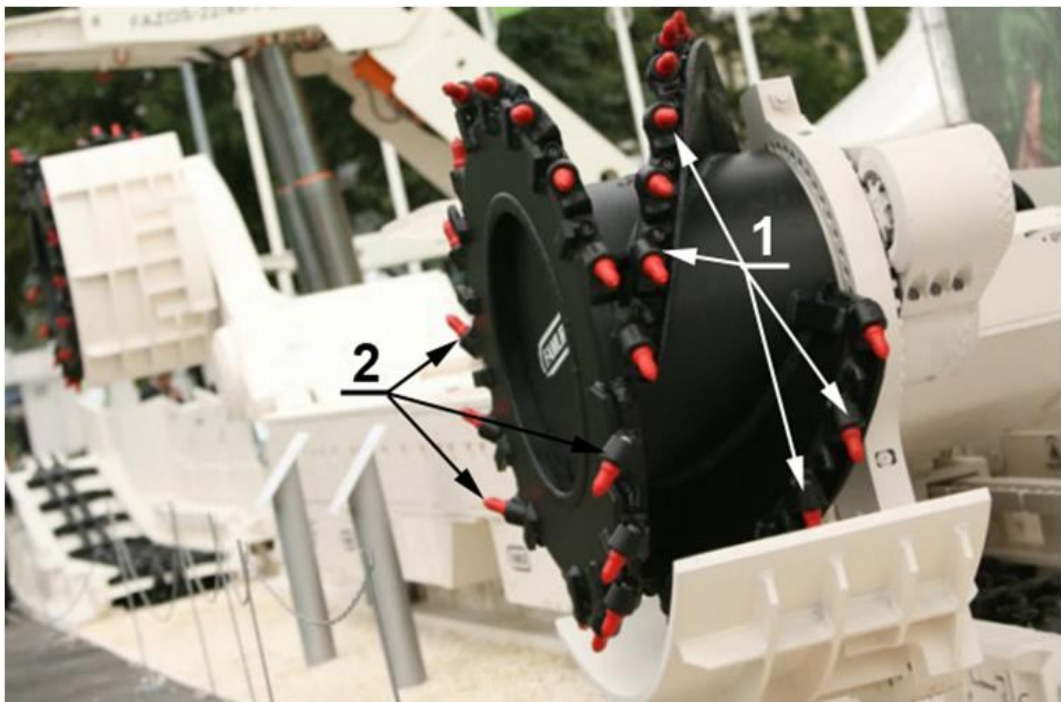
Rys. 5.6. Organ frezujący kombajnu ścianowego (na podstawie [28])
