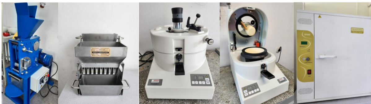
Rysunek 32 Etapy przygotowania prób soli do analizy składu: kruszarka szczękowa, aparat Jones'a, młynek agatowy, suszarka laboratoryjna
