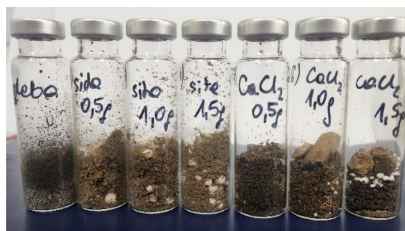
Rysunek 55. Wyniki testów próbek gleby oraz potwierdzenie skuteczności odwilgacania z wykorzystaniem chlorku wapnia (wizualna ocena)
