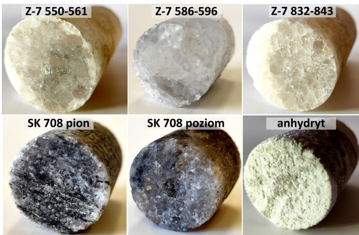
Rysunek 4. Próbki wytypowane do badań na współczynnik przepuszczalności względem helu
