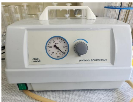
Rysunek 41. Pompa próżniowa do badania szczelności przygotowanych pułapek gazowych
