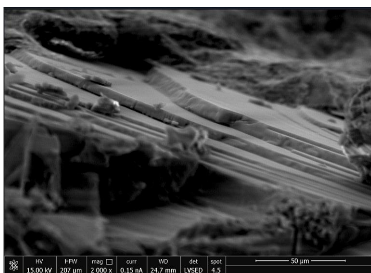
Rysunek 22. Halit z głębokości 1708 m – obraz SEM przedstawiający przekrój charakterystycznych płaszczyzn krystalicznych
