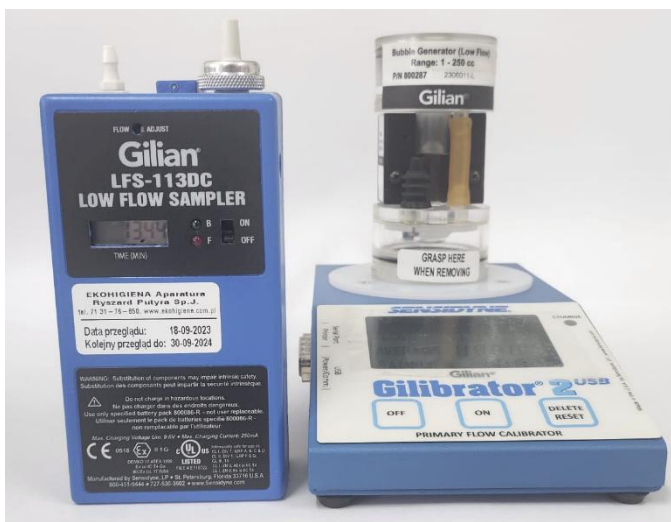
Rysunek 65. Zestaw: aspirator terenowy oraz zestaw do kalibracji przepływu
