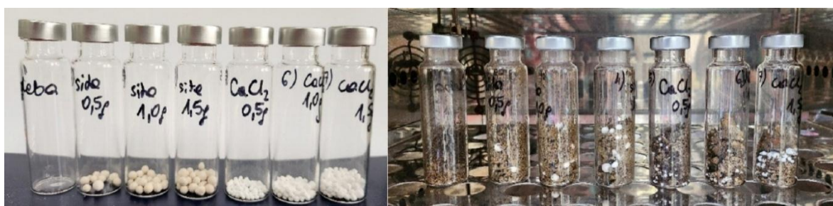
Rysunek 54. Testy laboratoryjne usuwania wilgoci z próbek z wykorzystaniem sit molekularnych i chlorku wapnia w różnych proporcjach
