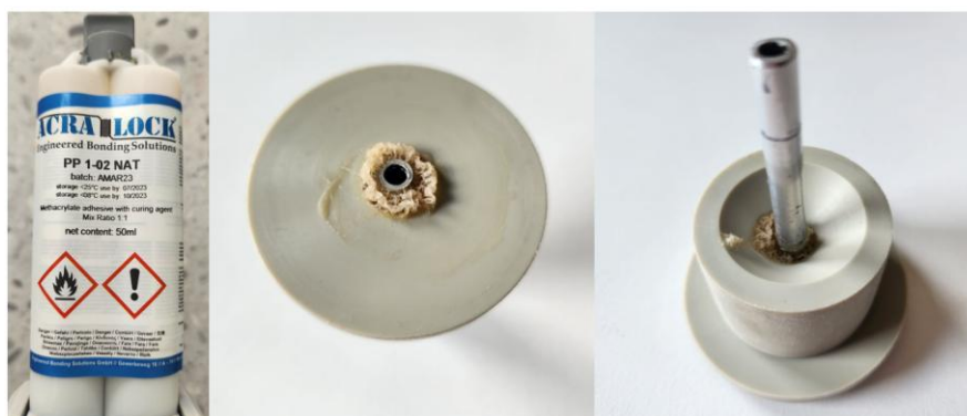
Rysunek 40. Testy łączenia metal-PPV
