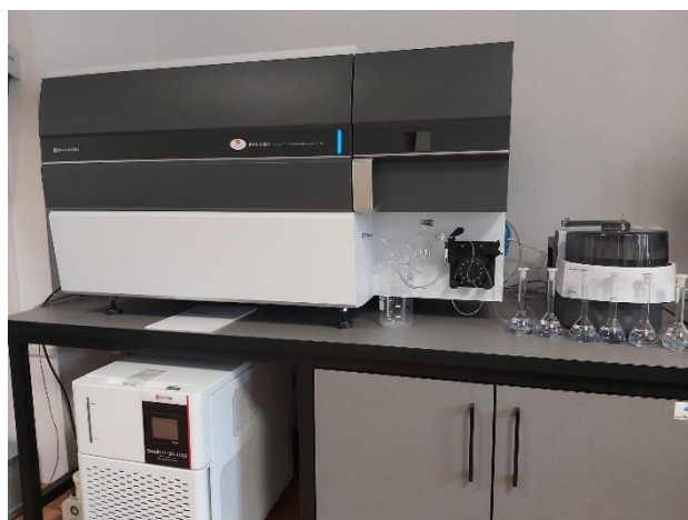
Rysunek 33. ICP-OES do oznaczeń metali ciężkich i pierwiastków śladowych [Autor zdjęcia: Małgorzata Gierek]
