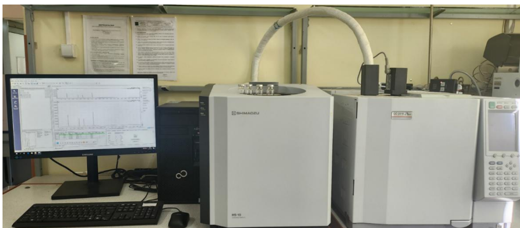
Rysunek 58. Układ chromatograficzny z detektorami typu FID i TCD oraz przystawką Headspace
