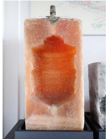
Rysunek 2. Model poglądowy przekroju kawerny solnej wylugowanej w bloku solnym. Autor zdjęcia: Małgorzata Gierek
