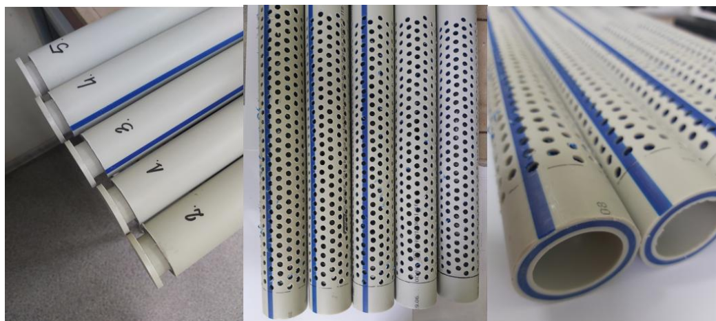
Rysunek 39. Elementy do budowy pułapki gazowej
