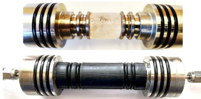
Rysunek 7. Zdjęcia przykładowej próbki przed i po jej uszczelnieniu [Autor: Pracownia Mikromerytyki, Instytut Mechaniki Górotworu PAN]
