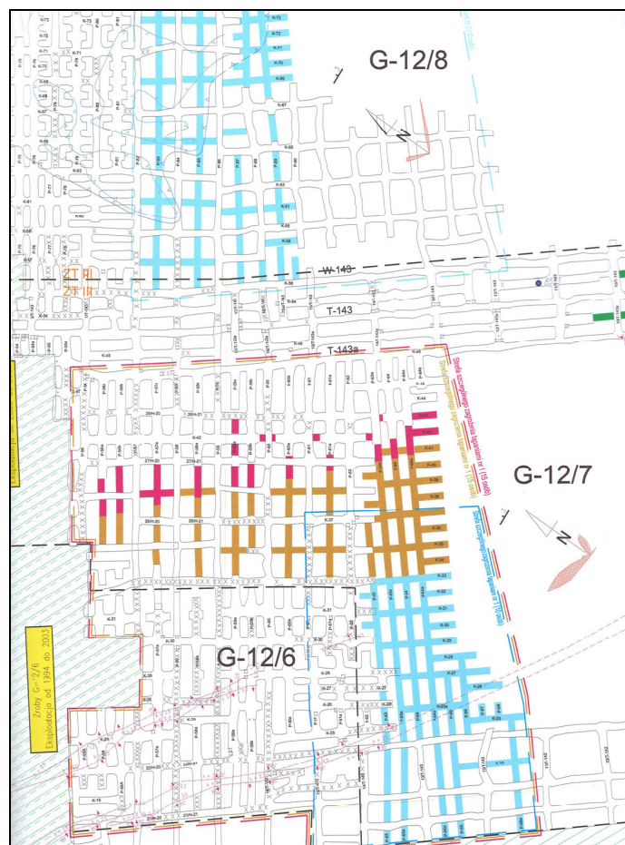
Rys. 7. Zakres prowadzenia dalszych robót rozrównujących w polach G-12/6,7,8, na podstawie aktualizacji Technicznego Projektu Eksploatacji z września 2004 r.
