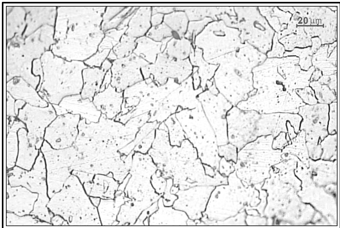
Rys.A12. Przykładowe mikrostruktury stali I austenitzowanej przy temperaturze 960°C i chłodzonej z prędkością 10.0°C/s. Struktura ferrytyczna. Średnia wielkość ziaren 11.1 \pm 2.4 \mu\text{m} . Trawiono 6% nitałem.
