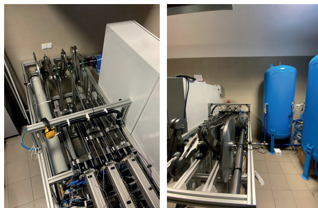
Rys. 12. Trójcyldrowy ekspander powietrza
