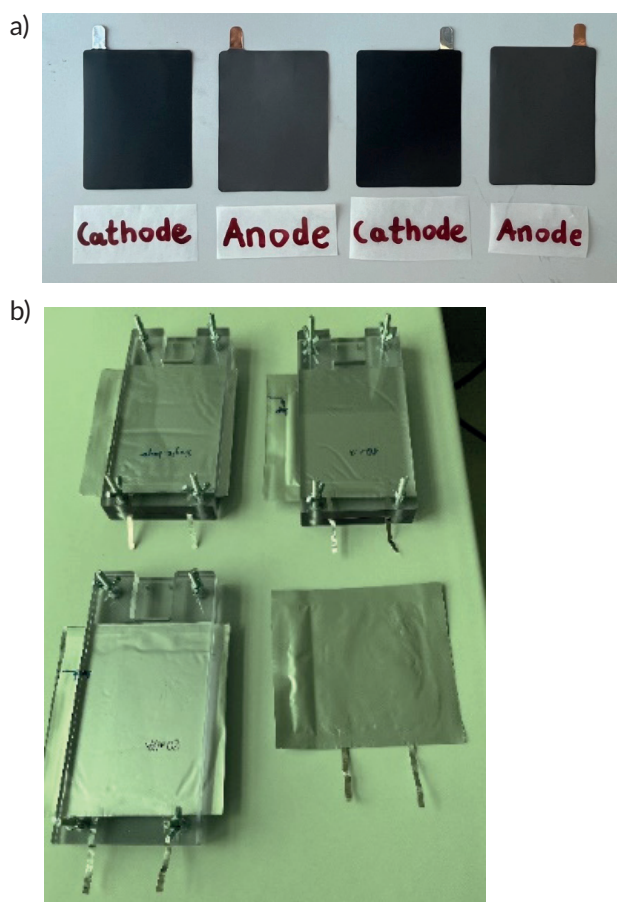
Rys. 6. Ogniwa typu pouch-cell: a) elementy składowe ogniw; b) kompletne ogniwa
