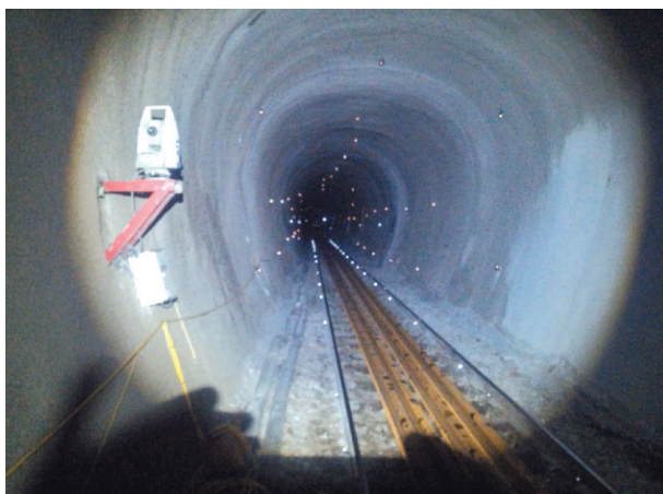
Rys. 3.28. Urządzenie geodezyjne oraz punkty pomiarowe na konturze tunelu (Geodata, b.d.)
