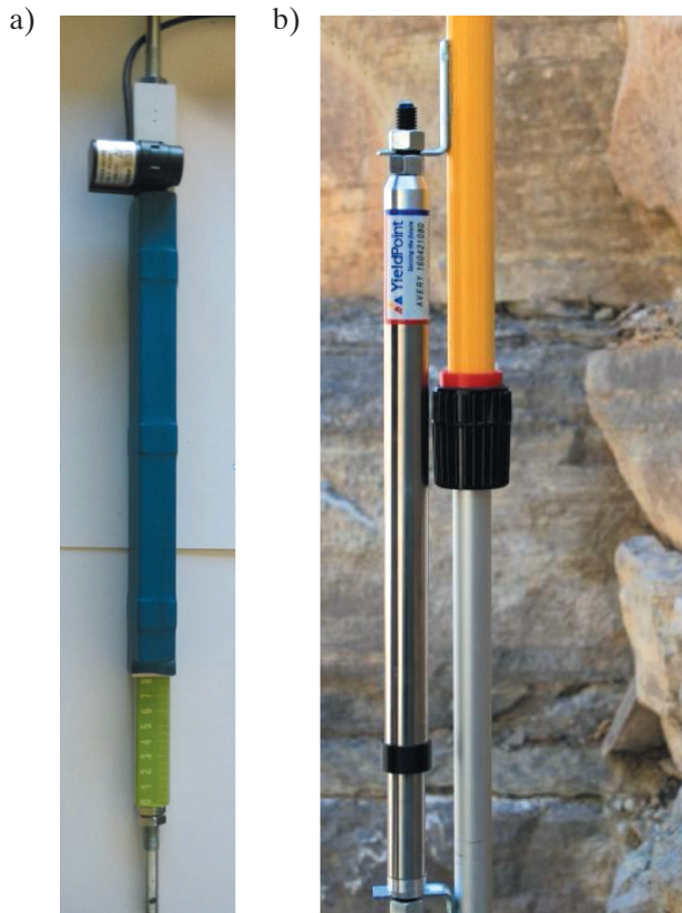
Rys. 3.22. Konwergometr automatyczny: a) typu KG1 DTSS (YieldPoint, b.d.-b); b) typu dConv (YieldPoint, b.d.-a)
