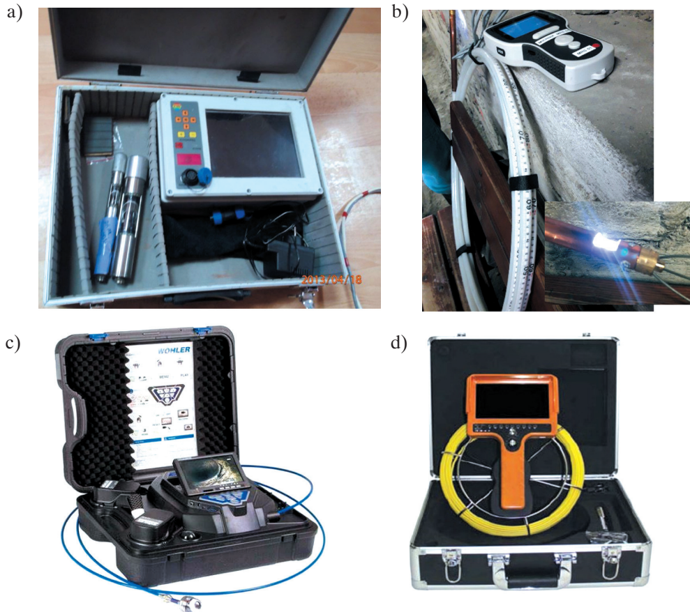
Rys. 3.111. Zestawy kamer endoskopowych do obserwacji otworów wiertniczych: a) kamera opracowana w ZG Lubin; b) endoskop MRS-01; c) kamera inspekcyjna WöhlerVIS-350 (Pascal, b.d.); d) kamera inspekcyjna hydrauliczna Wopson WPS-710DM-SCJ (NDN Sprzęt Kontrolno-Pomiarowy, b.d.)
