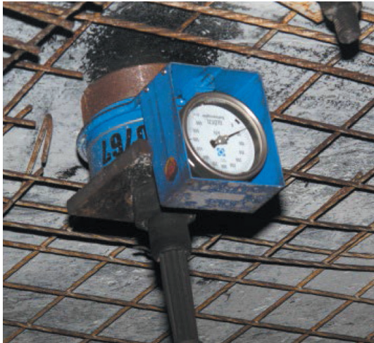
Rys. 4.34. Hydrauliczny dynamometr do pomiaru siły w kotwie z manualnym odczytem: a) wersja z manometrem prostopadłym do stropu; b) wersja z manometrem równoległym do stropu
