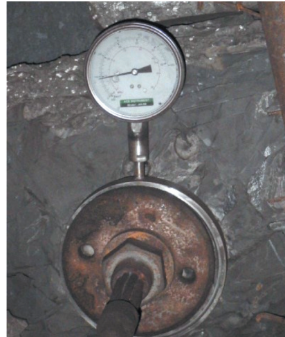
Rys. 4.34. Hydrauliczny dynamometr do pomiaru siły w kotwie z manualnym odczytem: a) wersja z manometrem prostopadłym do stropu; b) wersja z manometrem równoległym do stropu
