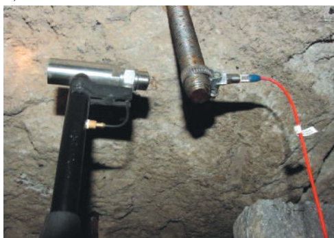
Rys. 4.59. Schemat badania ultradźwiękowego służącego do określania jakości wklejenia kotew: a) kotwa z przyłożonym czujnikiem i młotek udarowy (Staniek, 2005); b) przenośne urządzenie odczytowe (Staniek, 2021)
