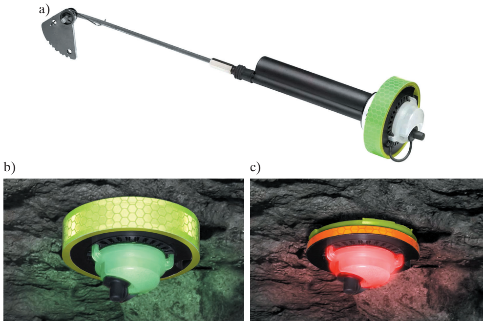
Rys. 3.77. Wskaźnik ledowy rozwarstwienia – Dual FOGlight: a) budowa wskaźnika; b) stan bezpieczny – krążek z zieloną LED; c) stan awaryjny – krążek z pomarańczową LED (New Concept Mining, b.d.)
