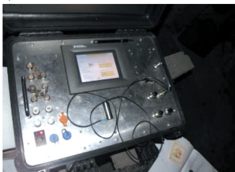
Rys. 4.59. Schemat badania ultradźwiękowego służącego do określania jakości wklejenia kotew: a) kotwa z przyłożonym czujnikiem i młotek udarowy (Staniek, 2005); b) przenośne urządzenie odczytowe (Staniek, 2021)
