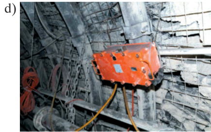
Rys. 3.94. Ekstensometr z drgającą struną: a) schemat instalacji VW Rod Extensometer (ACE Instrument, b.d.-d – zmodyfikowany); b) model 1391 z prętami z włókna szklanego; c) ekstensometr zamontowany w stropie chodnika; d) rejestrator w obudowie przeciwybuchowej
