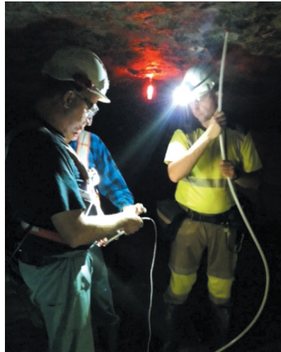
Rys. 3.114. Zastosowanie kamery endoskopowej w trakcie badania
