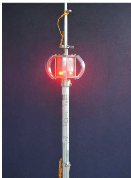
Rys. 3.51. Sygnalizator przyrostu konwergencji (Matusz i Szczerbiński, 2013)
