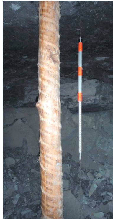
Rys. 3.21. Konwergometr zabudowany w wyrobisku w komorze przy zrobach
