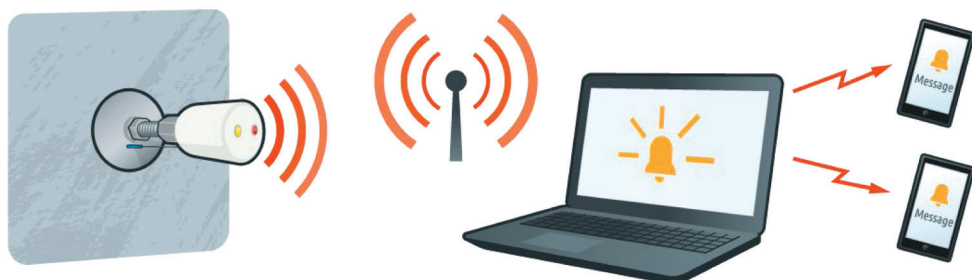
Rys. 4.58. Monitoring wydłużenia kotwy przy użyciu systemu Bolt Status Online (Rock Safety Systems, b.d.)
