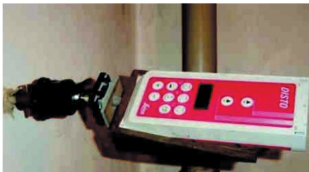
Rys. 3.27. Miernik laserowy zabudowany na stałe (Janowska i Kwaśniak, 2015)
