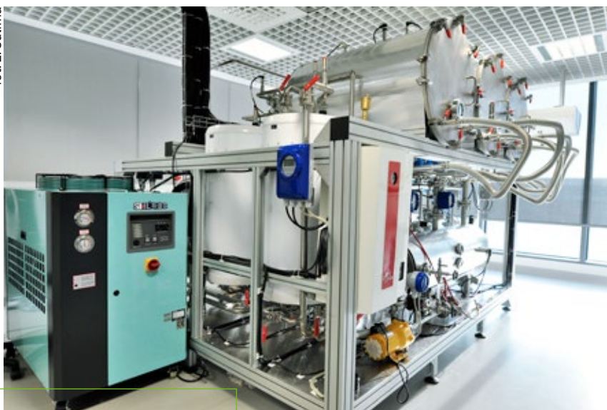
Laboratorium układów chłodzenia oparte o chłodziarkę adsorpcyjną z funkcją odsalania w Centrum Energetyki AGH
