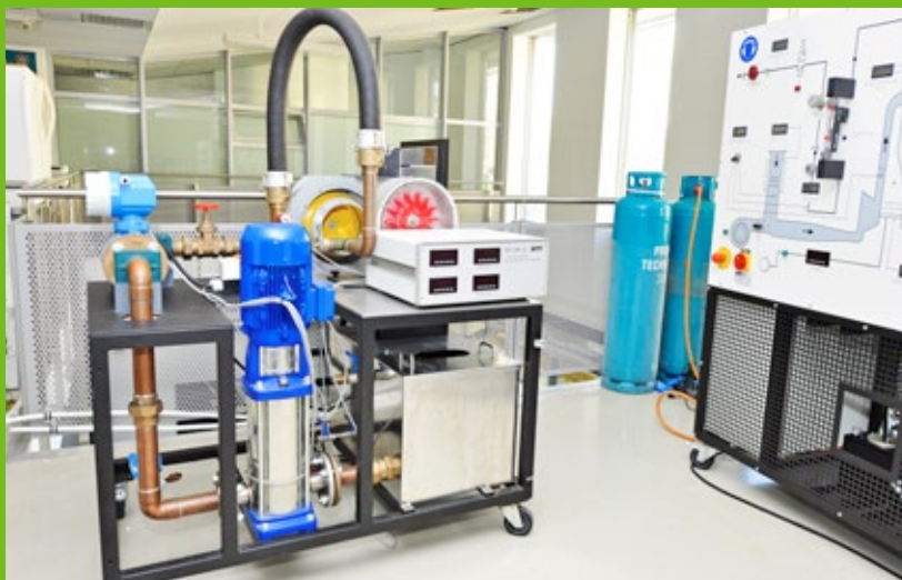
Stanowisko do badania pomp
