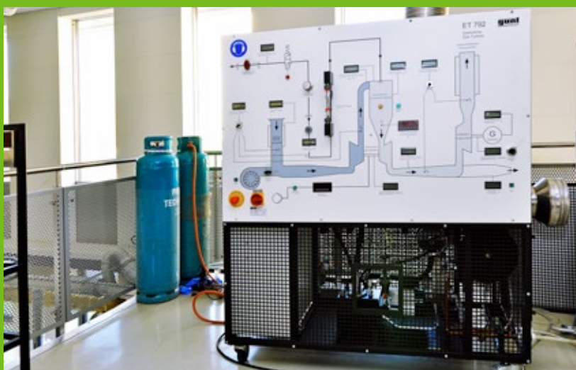
Tablica sterownicza turbiny gazowej
