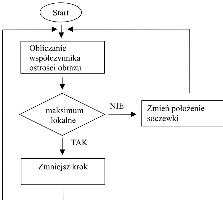
Rys. 2. Schemat algorytmu ustawiania ostrości obrazu z kamery
