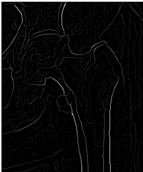
Rysunek A.4: Wynik eliminacji pikseli o niemaksymalnej wartości ( opracowanie własne ).
