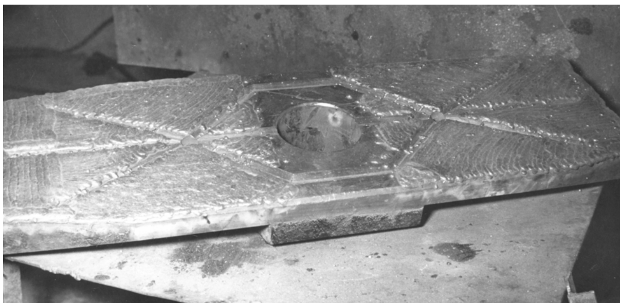
Rys. 2.16. Wkład wahliwy łącznika przegubowego zgniatacza z napawaną powierzchnią roboczą [5]
