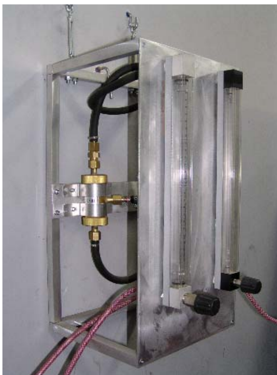
Rys. 9.2. Widok ogólny stanowiska do regulacji składu chemicznego i natężenia przepływu mieszanek gazowych dwuskładnikowych
