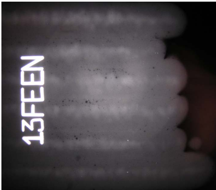
Rys. 10.60. Obraz radiograficzny jednowarstwowej próbki napawanej brązem
