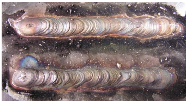
Rys. 10.62. Ślady wypalonego preparatu silikonowego wokół napoin z brązu
