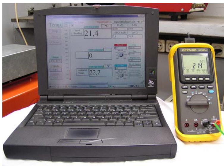
Rys. 9.4. Widok zestawu do pomiaru i rejestracji temperatury
