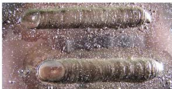
Rys. 10.4. Napoiny uzyskane z zastosowaniem dodatkowej szerszej dyszy gazowej uchwytu spawalniczego i niezależnym podawaniem gazu osłonowego
