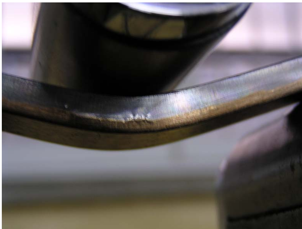
Rys. 10.67. Widok próbki jednowarstwowej i rolki dociskowej wraz z widocznymi pęknięciami między napoiną a materiałem podłoża
