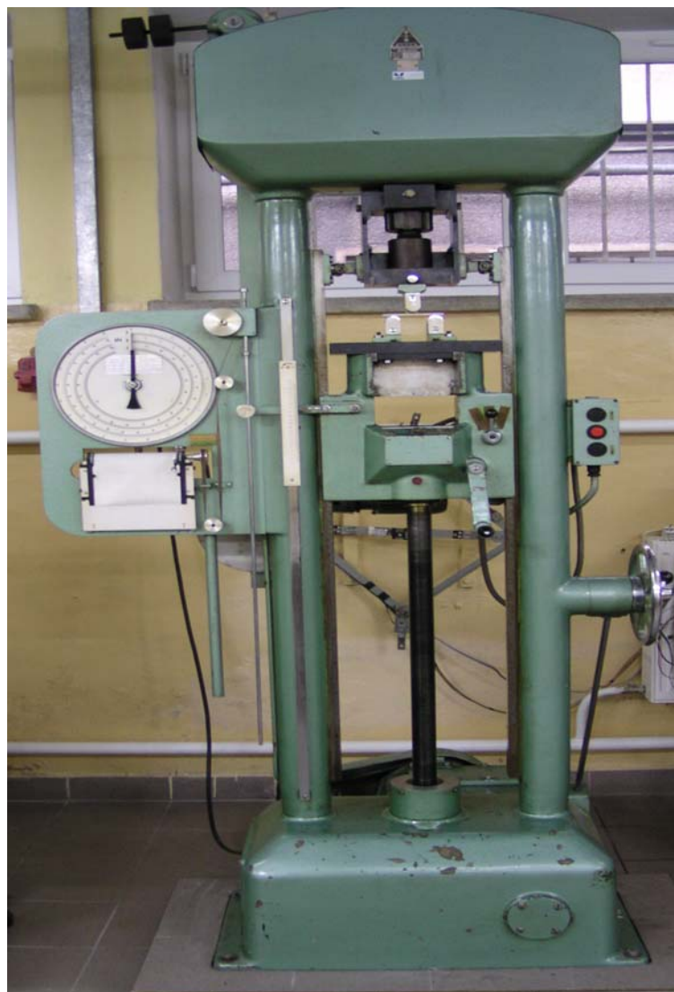
Rys. 10.64. Uniwersalna maszyna wytrzymałościowa wraz przyrządem do próby zginania
