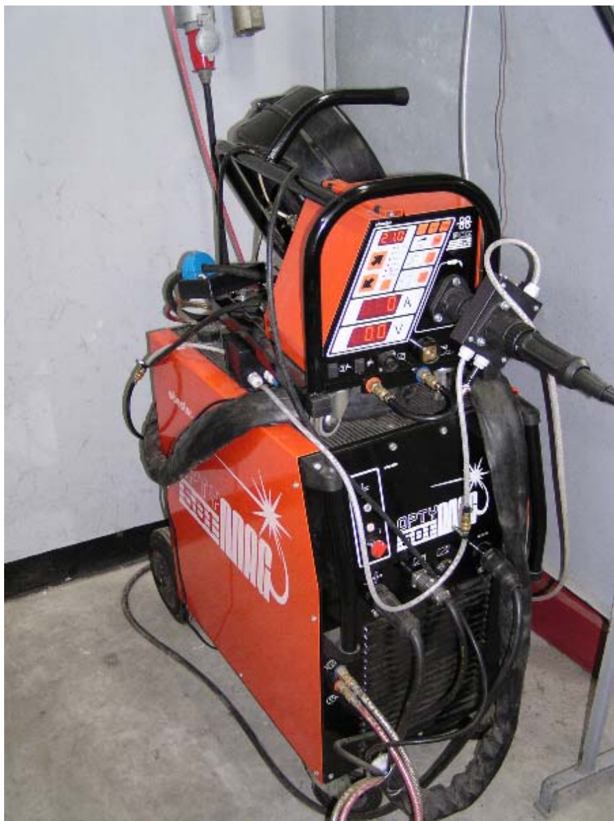
Rys. 9.1. Półautomat spawalniczy OPTYMAG 501 używany podczas badań napawania brązu na podłoże stalowe
