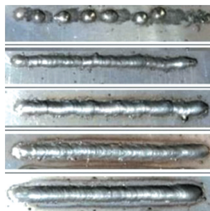
Rys. 5. Napawanie przy natężeniu prądu 150 A
