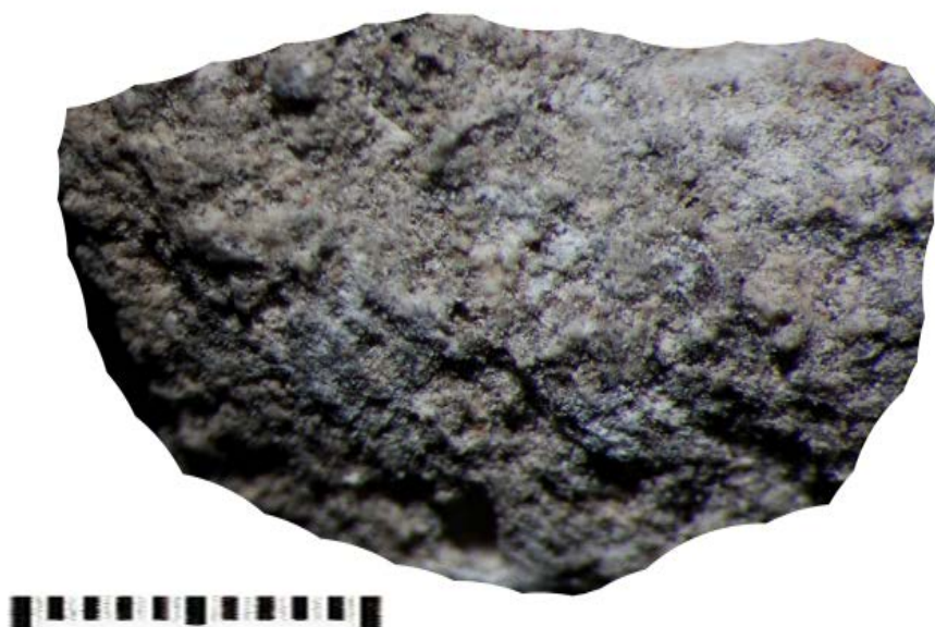
Fot. 8 Szara zaprawa wapienna z grobu Chrystusa. Wapno cementuje okruchy wapienne (brak piasku kwarcowego). Skala – mm.
