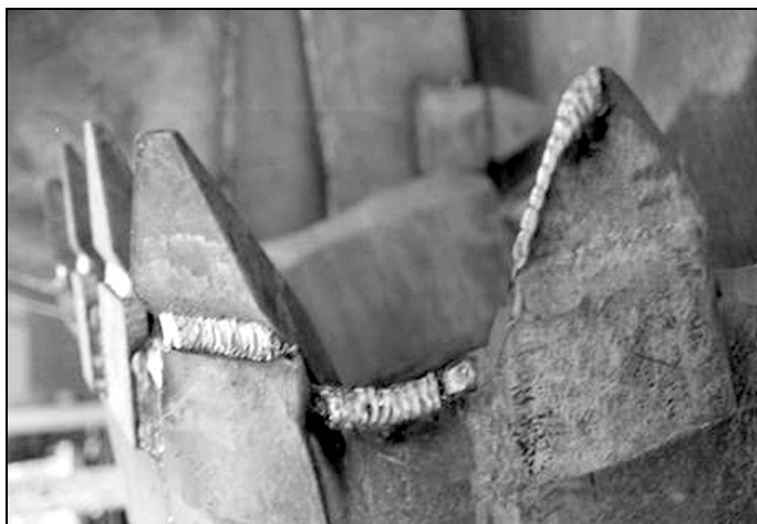
Rys. 7. Napawane zęby kute i nóż pomiędzy zębami [7]
