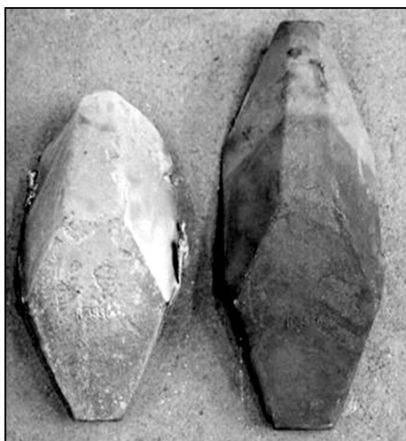
Rys. 6. Ząb kuty nowy i zużyty ścieranie [7]
