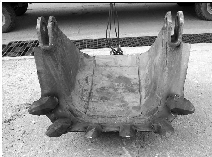
Rys. 4. Zęby kute o kształcie ostrosłupowo-klinowym wspawane na nożu czerpaka
