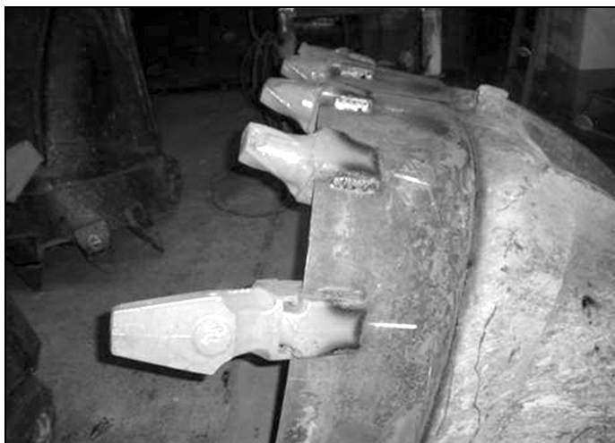
Rys. 10. Ząb firmy ESCO i adaptory zamontowane na nożu czerpaka [12]
