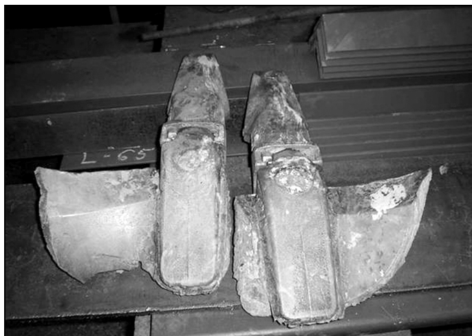
Rys. 11. Uszkodzenie noża z zębami firmy ESCO [12]
