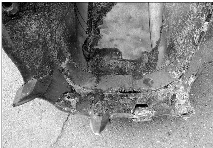
Rys. 8. Zużyte zęby kute i uszkodzony nóż czerpaka
