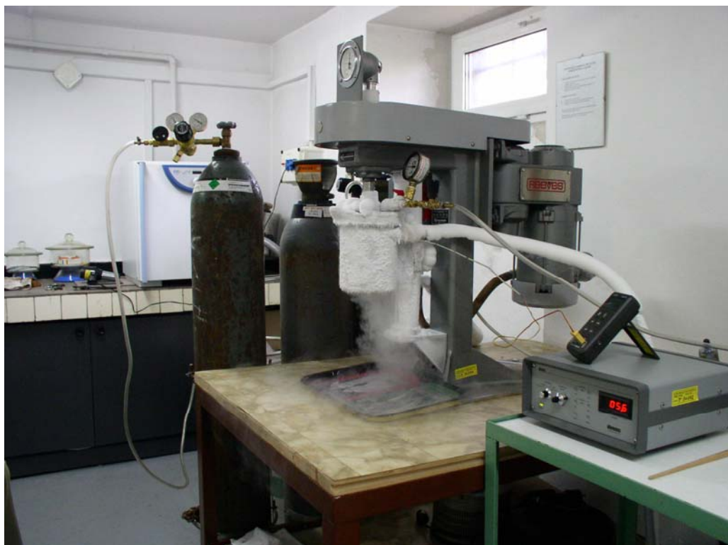
Rys. 22. Attritor podczas mechanicznej syntezy z chłodzeniem ciekłym azotem
