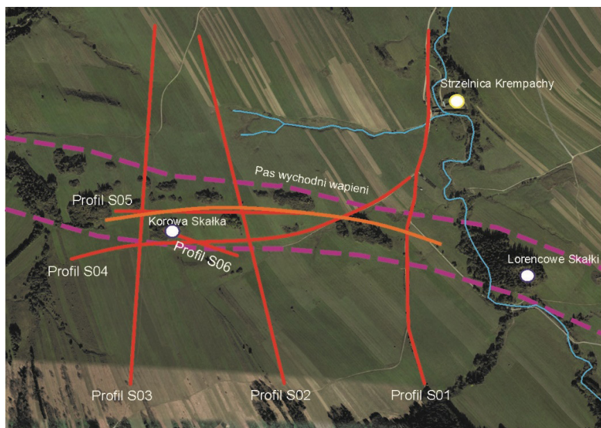
Rys. 6.13. Interpretowana sejsmiczna granica pomiędzy jednostką braniską a formacją jarmucką (pomarańczowa linia). Wapienie jednostki braniskiej występują po jej południowej stronie, a piaskowce formacji jarmuckiej po północnej. Legenda – patrz rysunek 6.4
