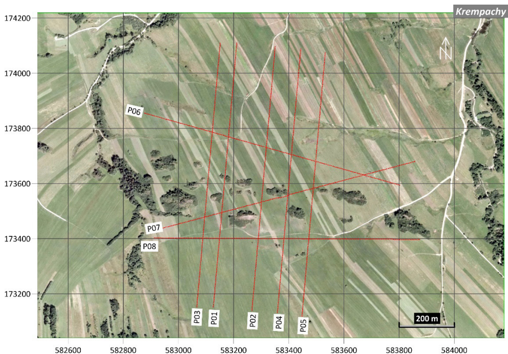
Rys. 5.5. Lokalizacja profili ERT2D. Numeracja profili zgodna z kolejnością ich wykonywania (podkład: ortofotomapa – Google Earth, układ PL-1992)
