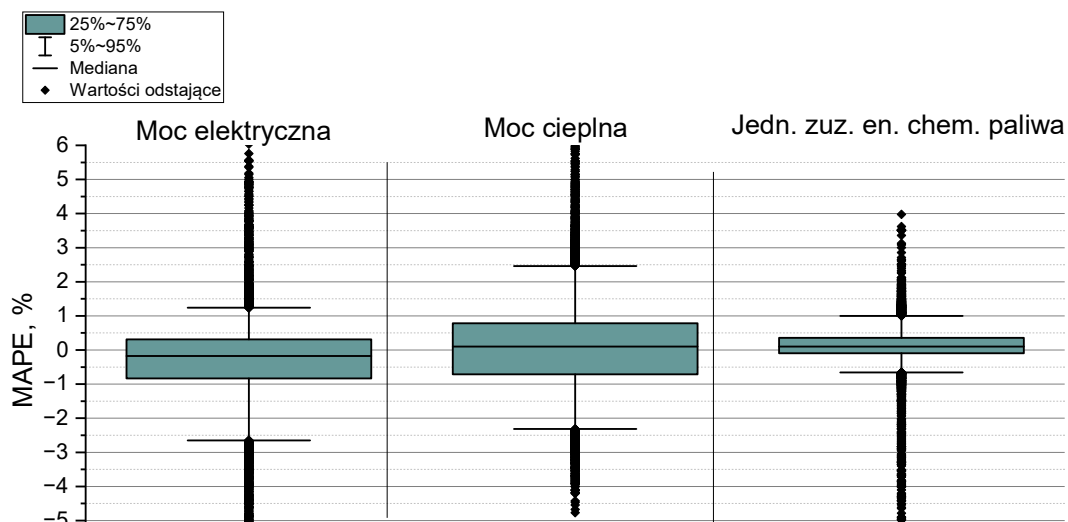
Rys. 6.23 Statystyka godzinowych błędów względnych prognozy mocy elektrycznej, mocy cieplnej i jednostkowego zużycia energii chemicznej paliwa dla turbiny GT1 (dla modelu m04 i okna treningowego 15 dni)
