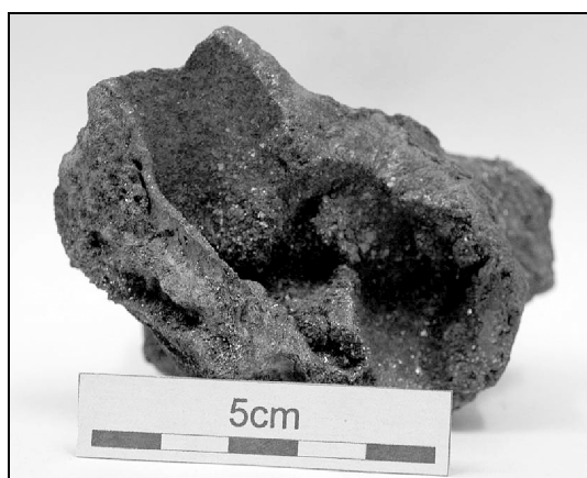
Rys. 4. Fragment komina zbudowanego z pirytu i chalkopirytu z, obszar złóżowy firmy Interoceanmetal, Clarion-Clipperton, Pacyfik
