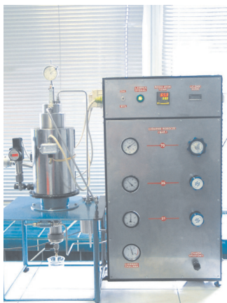
Rys. 5. Aparat do badania migracji gazu przez wiążący zaczyn cementowy (konstrukcja INiG)
