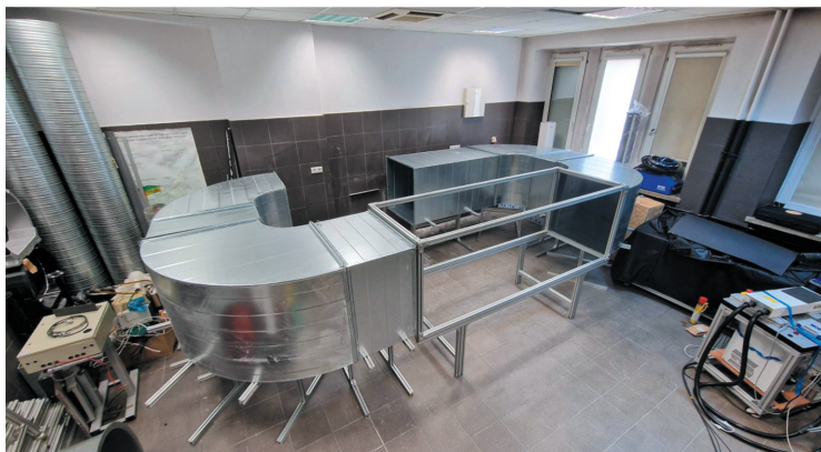
Rys. 6. Zdjęcie zbudowanego tunelu aerodynamicznego. Na zdjęciu tunel pozbawiony jest wentylatora oraz ścian bocznych w sekcji pomiarowej
