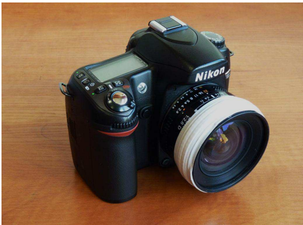
Rys. 6 Lustrzanka cyfrowa Nikon D80 z obiektywem stało ogniskowym Nikon Nikkor 20 mm f/2.8D. W aparacie włączony jest tryb MF a obiektyw posiada unieruchomiony taśmą pierścień ostrości w celu stabilizacji odległości obrazowej. Na dolnej powierzchni korpusu oznaczono gwint na śrubę statywową (A) oraz zagłębienie (B) umożliwiające przymocowanie aparatu do platformy systemu (Rys. 7, Rys. 8).
