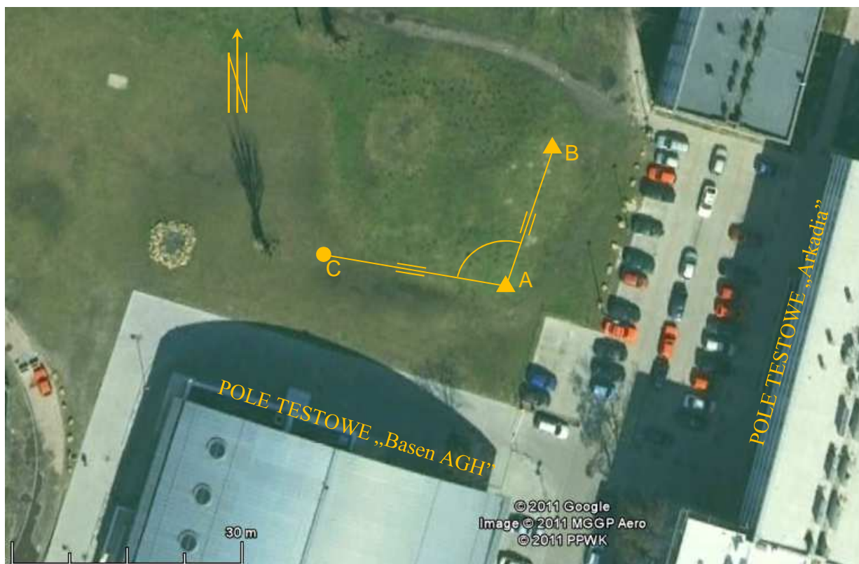
Rys. 26 Szkic osnowy pomiarowej dla wyznaczenia współrzędnych punktów pól testowych „Arkadia” i „Basen”.
