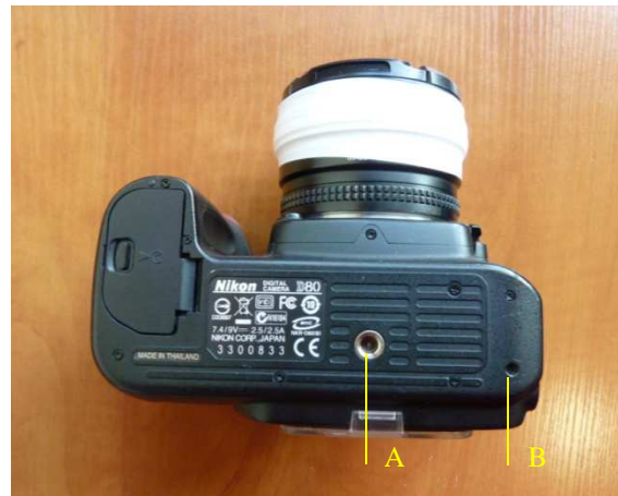
Rys. 6 Lustrzanka cyfrowa Nikon D80 z obiektywem stało ogniskowym Nikon Nikkor 20 mm f/2.8D. W aparacie włączony jest tryb MF a obiektyw posiada unieruchomiony taśmą pierścień ostrości w celu stabilizacji odległości obrazowej. Na dolnej powierzchni korpusu oznaczono gwint na śrubę statywową (A) oraz zagłębienie (B) umożliwiające przymocowanie aparatu do platformy systemu (Rys. 7, Rys. 8).
