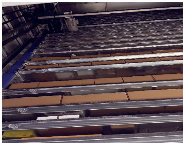
Rys. 6. Wnętrze regału autonomicznego z widocznymi tacami
