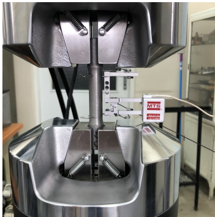
Rysunek 3.23 Próbką zamocowana w szczękach hydraulicznych wraz z ekstensometrem MTS 643.31F-24
