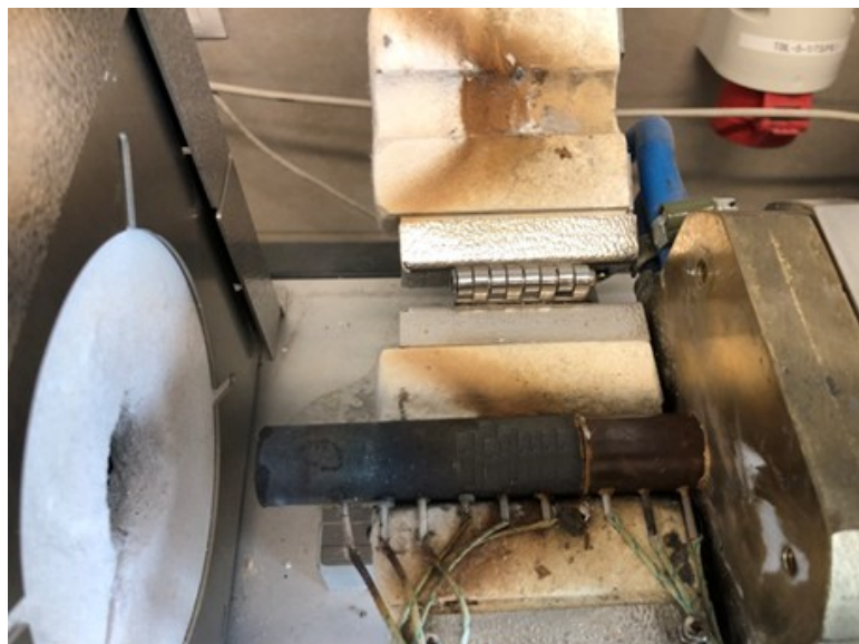
Rysunek 3.44 Układ pomiarowy przygotowany do badań przewodności cieplnej
