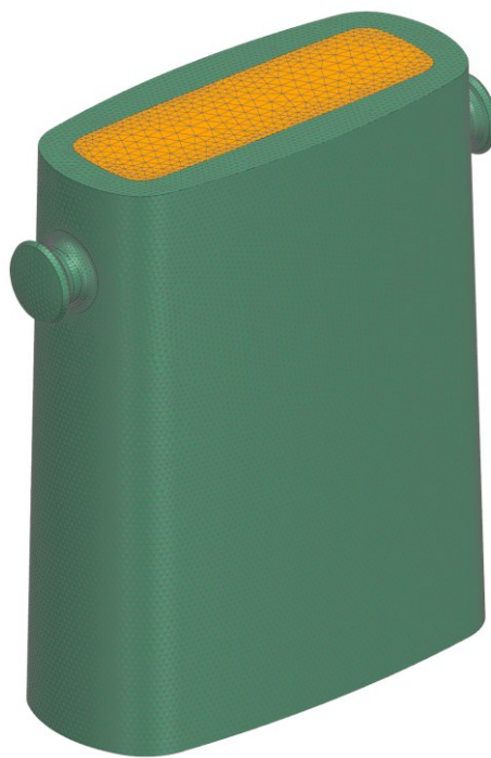
Rysunek 3.55 Model numeryczny wlewnicy wraz z wlewkiem stalowym
