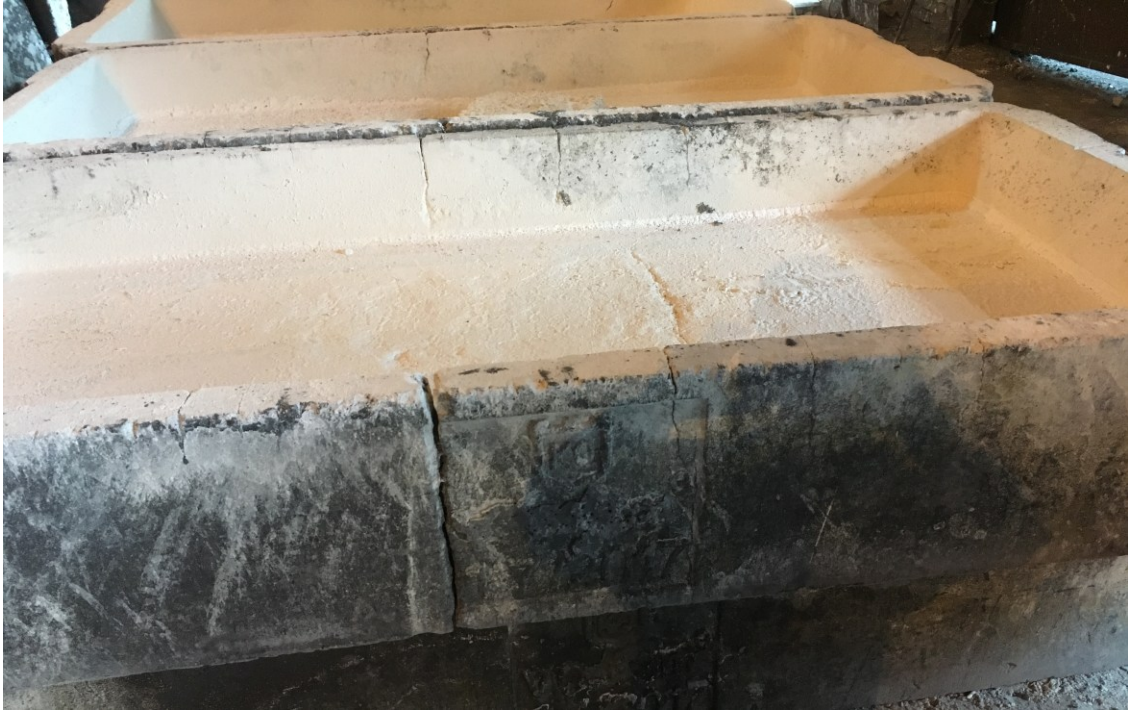
Rysunek 3.80 Rzeczywiste uszkodzenia wlewnicy w strefie krytycznej wskazanej na podstawie numerycznej analizy stanu naprężenia i odkształcenia – potwierdzenie zgodności z prognozą numeryczną
