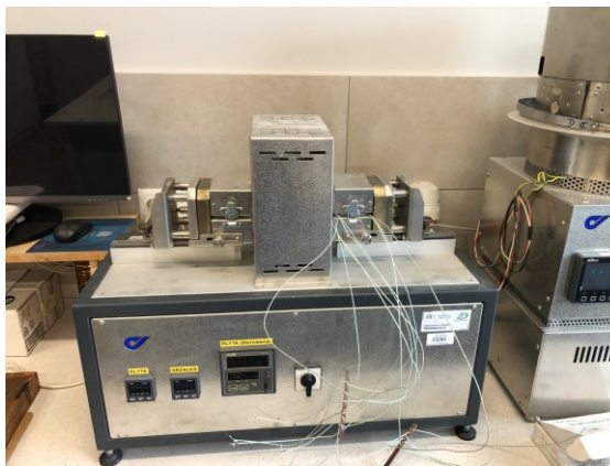
Rysunek 3.43 Prototypowe stanowisko do badania przewodności cieplnej
