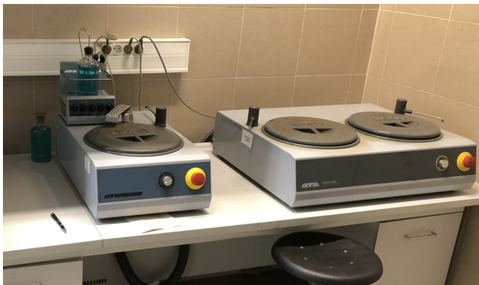
Rysunek 3.48 Stanowisko przygotowania zglądów metalograficznych. Szlifierko-polerka Saphir 330 (z prawej) i polerka wysokoobrotowa Saphir 320 (z lewej)
