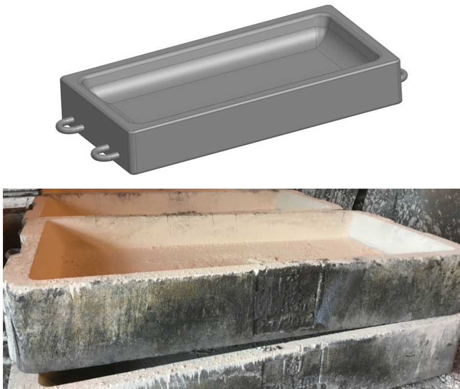
Rysunek 3.74 Geometria wlewnicy 0,43 m 3 do produkcji żelazostopów
