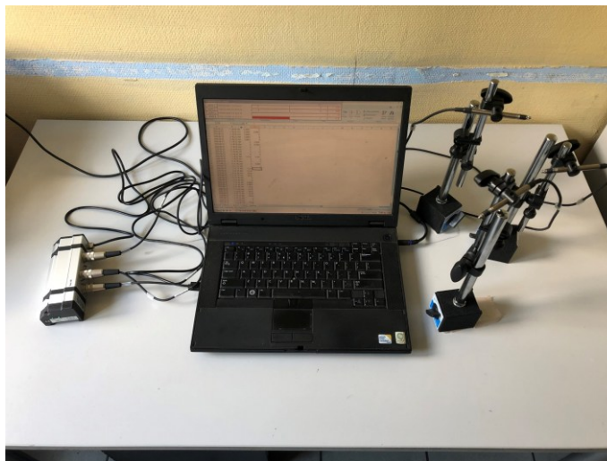
Rysunek 3.12 Aparatura pomiarowa przemieszczeń ścian wlewnicy
