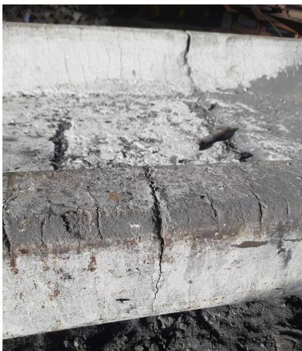
Rysunek 3.98 Pęknięcia wlewnicy po modyfikacji. Potwierdzenie lokalizacji stref niebezpiecznych z analizy numerycznej.
