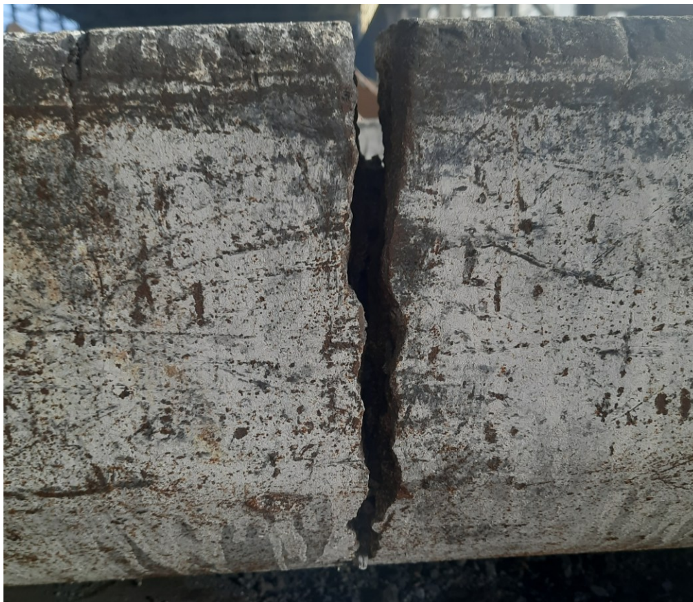
Rysunek 2.7 Pęknięcie ściany wlewnicy wywołane zmęczeniem cieplnym
