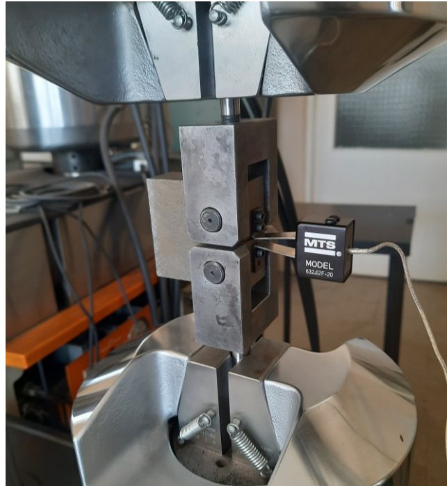
Rysunek 3.35 Próbką kompaktowa CT w szczękach hydraulicznych wraz z ekstensometrem MTS 632.02F-20
