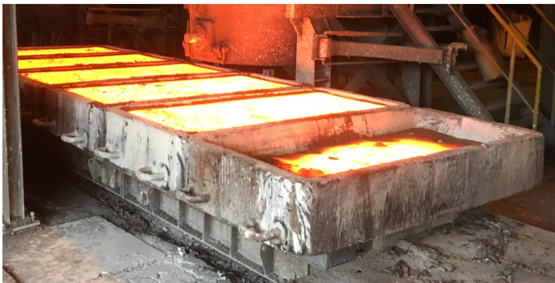
Rysunek 3.75 Zestaw wlewnic 0,43 m 3 po zalaniu
