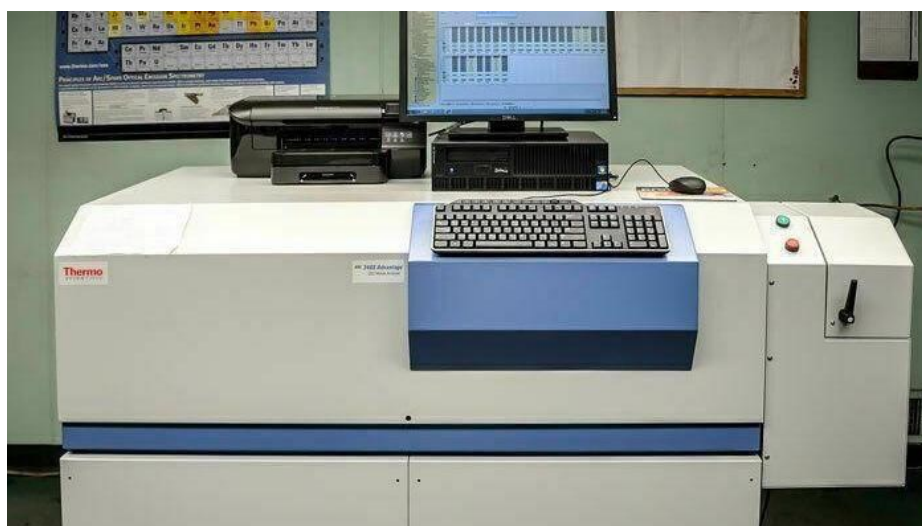
Rysunek 3.3 Spektrometr emisyjny ARL 3460 Advantage użyty do analizy składu chemicznego
