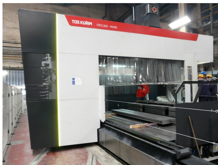
Rysunek 3.5 Frezarka bramowa sterowana numerycznie CNC TOS Kurim FRF-300/8
