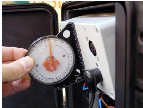
Rys. 6. Ustawienie kąta pochylenia radaru.
