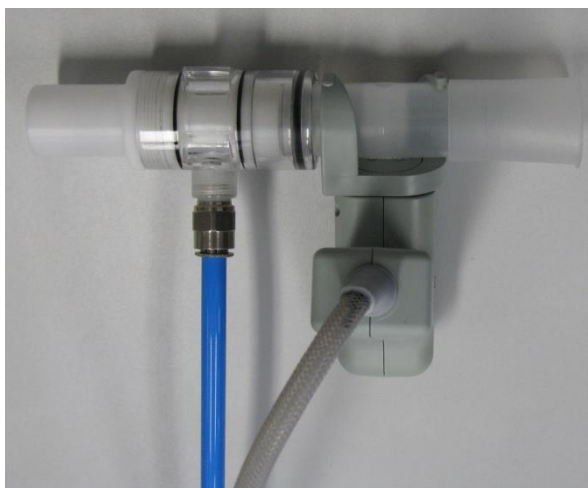
Rys. 5. Fragment systemu pomiarowego do badania NEP. Sposób montażu przewodu od kompresora z głowicą pomiarową.
