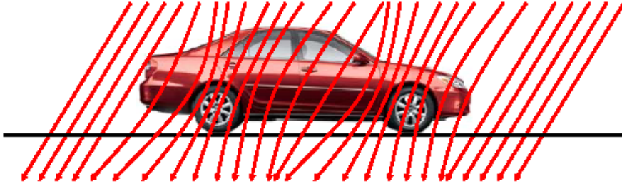
Rys. 1. Zmiana pola magnetycznego Ziemi wywołana przez przejeżdżający pojazd.
