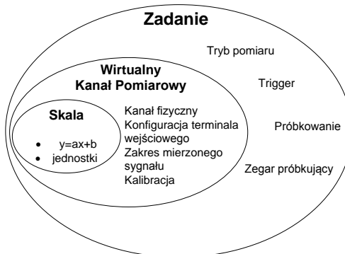
Rys. 3. Definicja zadania ( Task ) dla urządzenia obsługiwanego przez sterownik NI-DAQmx.
