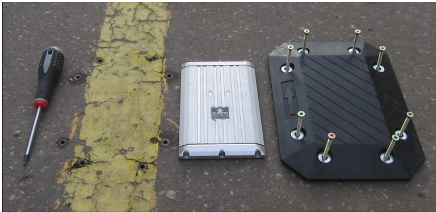
Rys. 2. Czujnik NC-200 z osłoną na terenowym stanowisku pomiarowym.
