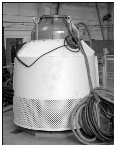
Rys. 12. Pompa OZ z płaszczem chłodzącym [6]
