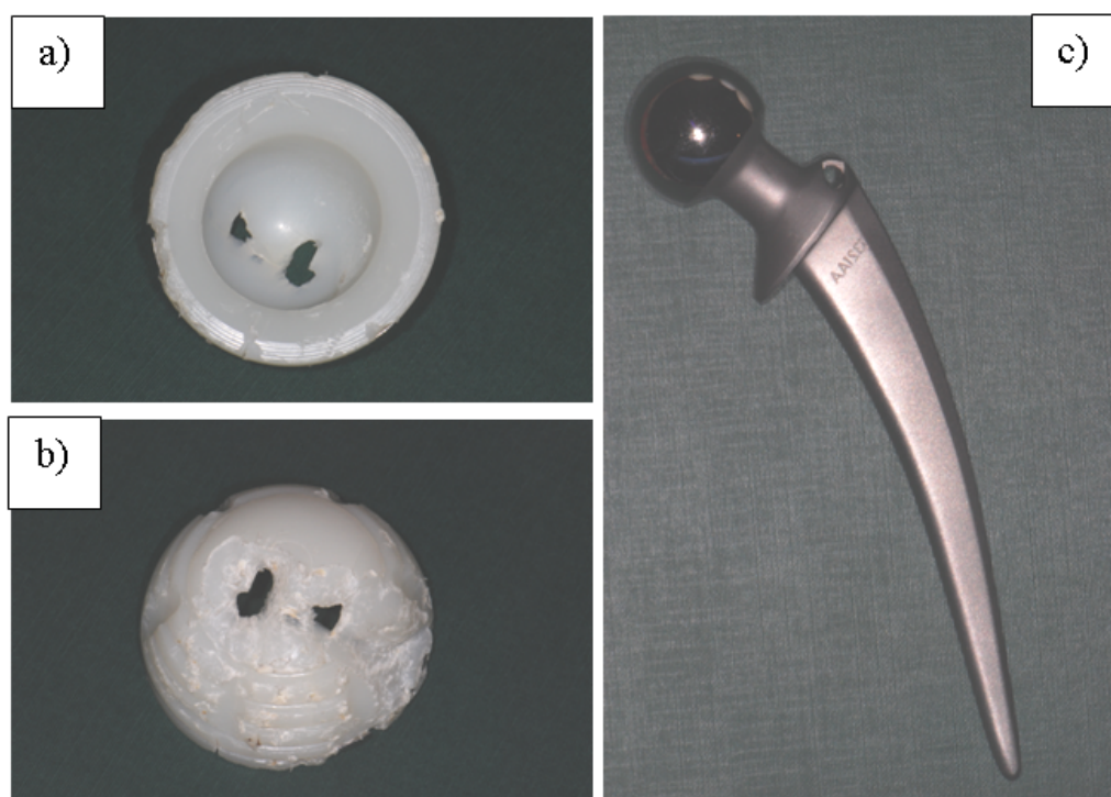
Rys. 8.20. Endoproteza cementowa typu Weber usunięta z powodu powikłań zabiegu alloplastyki: a) panewka Sulene ® -PE w widoku od strony skojarzenia z głową, b) panewka Sulene ® -PE w widoku od strony kontaktu z cementem, c) trzpień jednolity Protasul ® -10 spajany z głową Protasul ® -21 WF, Materiał pozyskany dzięki uprzejmości dr n. med. Janusza Cwanka.
