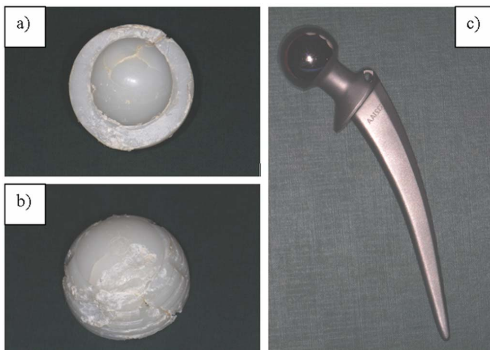
Rys. 8.19. Endoproteza cementowa typu Weber usunięta z powodu powikłań zabiegu alloplastyki: a) panewka Sulene ® -PE w widoku od strony skojarzenia z głową, b) panewka Sulene ® -PE w widoku od strony kontaktu z cementem, c) trzpień jednolity Protasul ® -10 spajany z głową Protasul ® -21 WF. Materiał pozyskany dzięki uprzejmości dr n. med. Janusza Cwanka.
