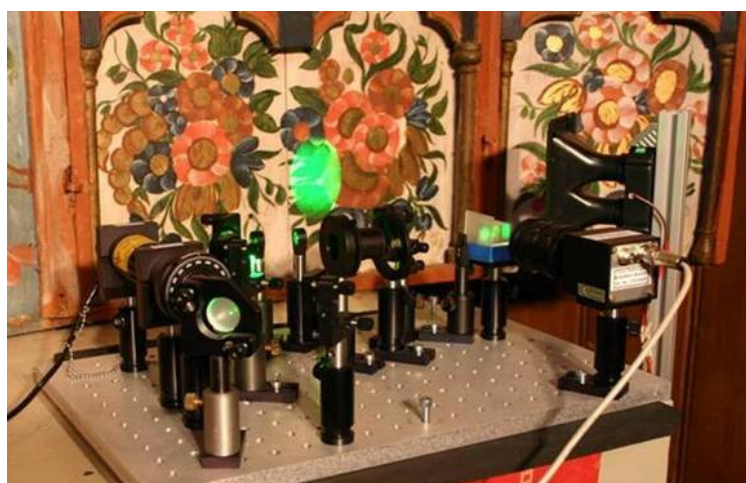
Rys. 63. Interferometr umieszczony w pobliżu ołtarza kościoła w Hedalen w Norwegii.
