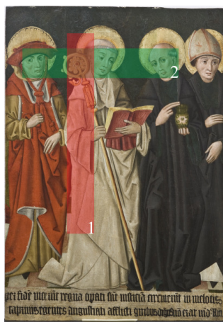
Rys. 66. ŚŚ Bonawentura, Bernard z Clairvaux, Benedykt z Nursii i Augustyn, koniec XV wieku, wymiary: 78cm x 56cm, tempera na desce, deska ścieniona, parkietowana. Kolorem zielonym oraz czerwonym zaznaczono obszary, na których przeprowadzono pomiary wykorzystując DSPI.
