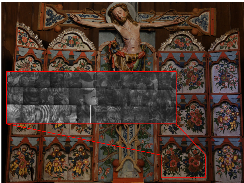
Rys. 62. Zdjęcie ołtarza z zaznaczoną powierzchnią, która była badana. Na mniejszej ilustracji znajduje się interferogram zrobiony przy użyciu DSPI ze wzbudzeniem termicznym.
