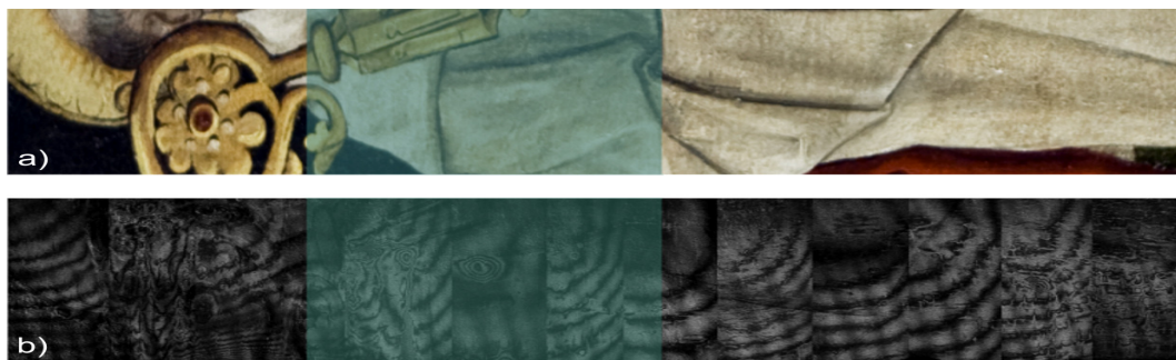
Rys. 68. Zestawienie interferogramu DSPI po wzbudzeniu termicznym (b) ze zdjęciem fotograficznym badanej powierzchni (a). Na rysunku (b) zaznaczono kolorem miejsca, w których był przeprowadzony pomiar z użyciem wzbudzenia akustycznego.
