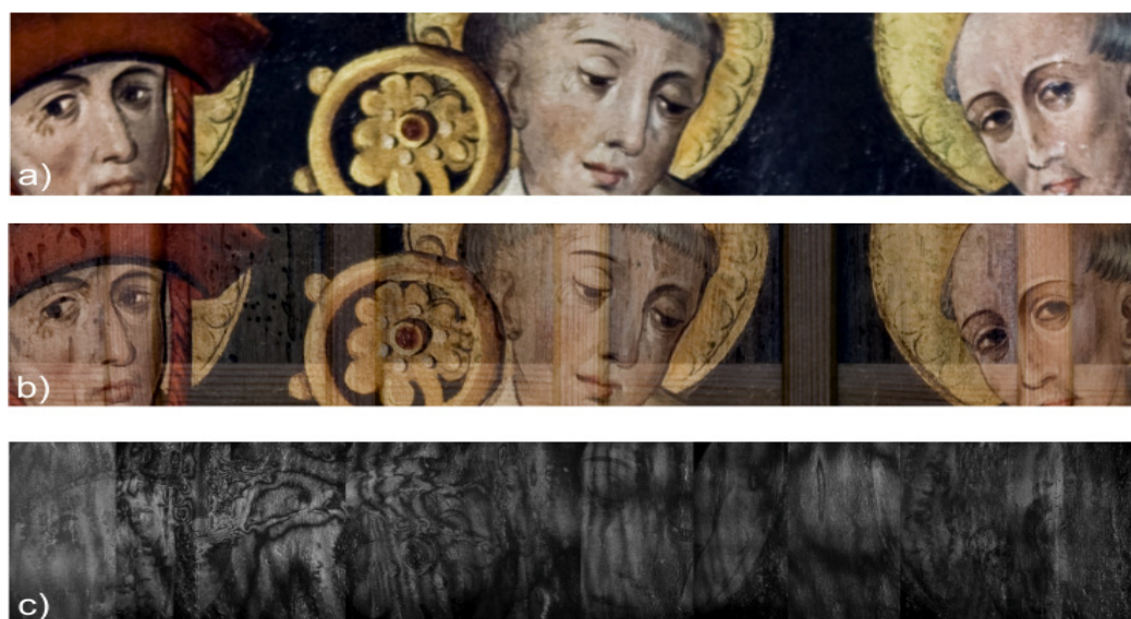
Rys. 67. Zestawienie interferogramu DSPI po wzbudzeniu termicznym (c) ze zdjęciem fotograficznym badanej powierzchni z nałożonym parkietażem (b) oraz samym zdjęciem fotograficznym badanej powierzchni (a).
