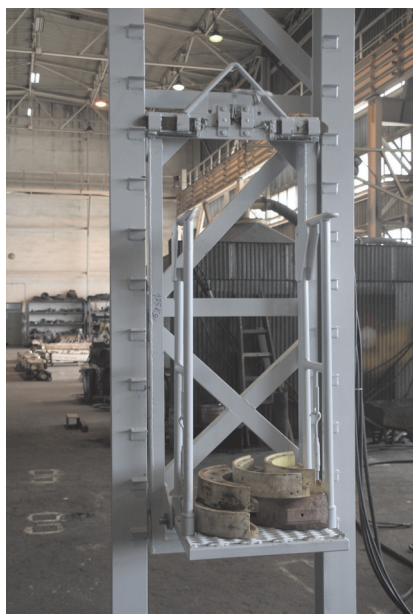
Rys. 4. Próba „zerwania” liny przy 22 mm odległości rygli od wsporników. Rygłe nie w pełni – na długości 24 mm zatrzaskują się na najbliższej parze wsporników
