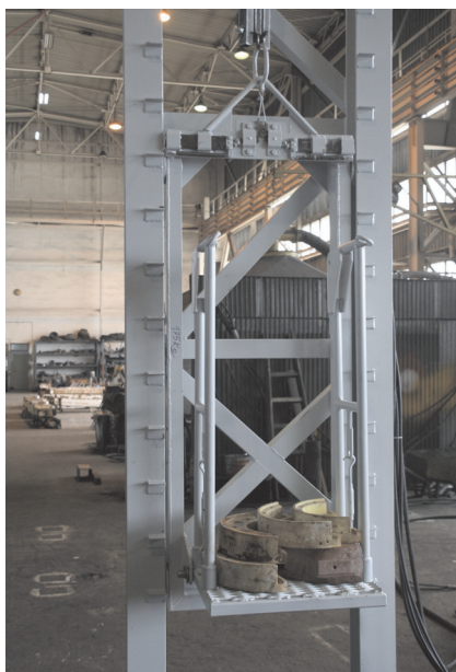
Rys. 4. Próba „zerwania” liny przy 22 mm odległości rygli od wsporników. Rygłe nie w pełni – na długości 24 mm zatrzaskują się na najbliższej parze wsporników
