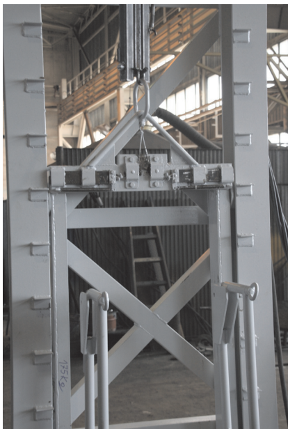
Rys. 3. Próba „zerwania” liny przy 15 mm odległości rygli od wsporników. Rygłe w pełni – na długości 50 mm zatrzaskują się dopiero na następnej parze wsporników
