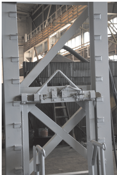
Rys. 3. Próba „zerwania” liny przy 15 mm odległości rygli od wsporników. Rygłe w pełni – na długości 50 mm zatrzaskują się dopiero na następnej parze wsporników
