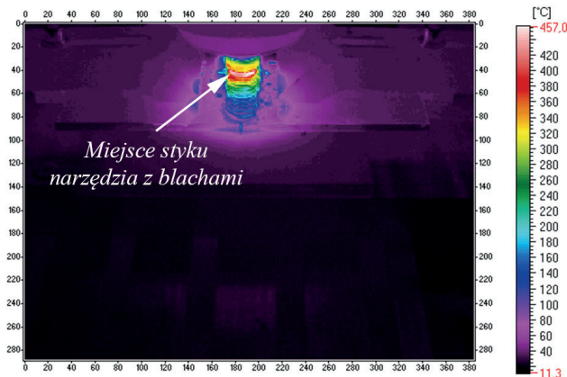
Rys. 33. Obraz procesu zgrzewania z kamery termowizyjnej
