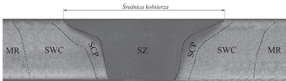
Rys. 10. Przekrój poprzeczny złącza FSW z zaznaczonymi strefami mikrostrukturalnymi na przykładzie złącza jednoimiennego. MR – materiał rodzimy, SWC – strefa wpływu ciepła, SCP – strefa ciepło-plastyczna, SZ – strefa mieszania
