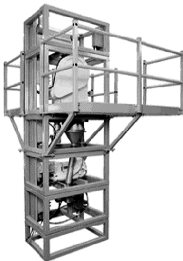
Rys. 1. Próbobiornik obrotowy z kruszarką i podzielnikiem M&W Jawo
