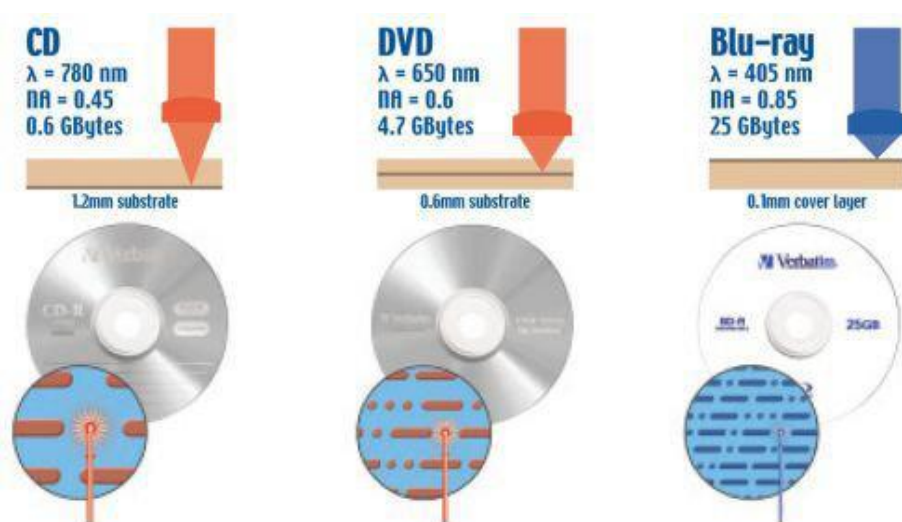
Rysunek 14 Porównanie płyt CD, DVD i Blu-Ray
