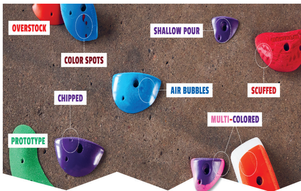
Rys. 30. Przykładowe uszkodzenia kwalifikujące chwytaki jako drugi gatunek
