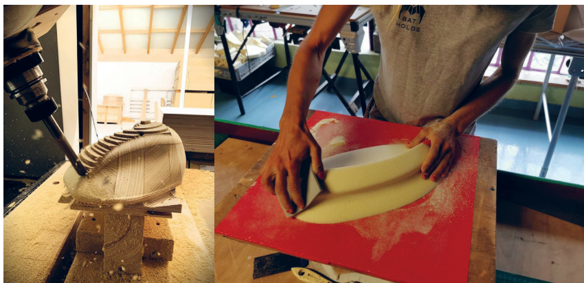
Rys. 15. Porównanie sposobów rzeźbienia prototypów – maszynowo oraz ręcznie
