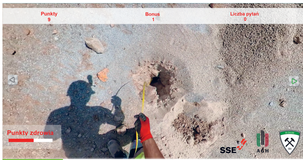
Rys. 6. Film 360° obrazujący proces mierzenia otworu strzałowego na etapie przygotowania robót strzałowych
