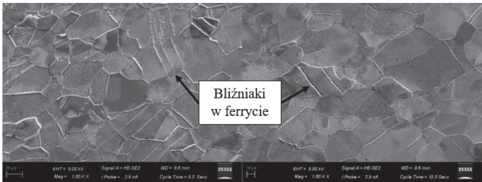
Rys. 5. Mikrostruktura żelaza armco po procesie platerowania, SEM, zgląd trawiony
