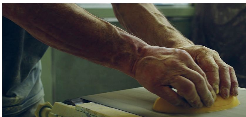
Rys. 23. Szlifowanie krawędzi chwytu
