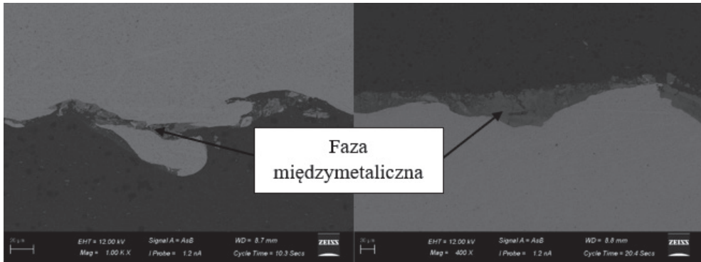
Rys. 9. Złącze stop Al 1050 – tytan Gr. 1, SEM
