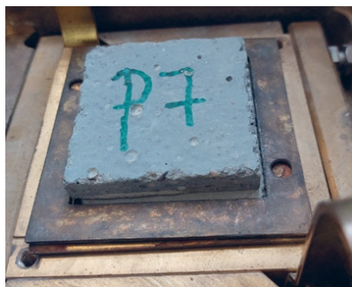
Rys. 3. Prawidłowe ustawienie próbki w aparacie bezpośredniego ścinania
