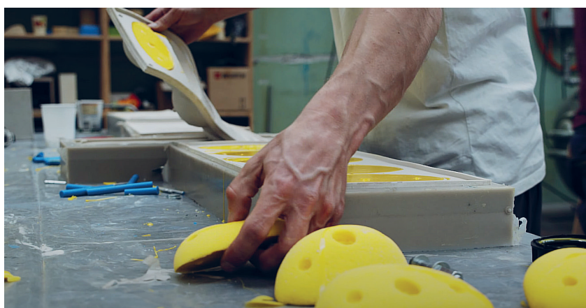
Rys. 22. Wyjmowanie utwardzonych chwytów z form silikonowych
