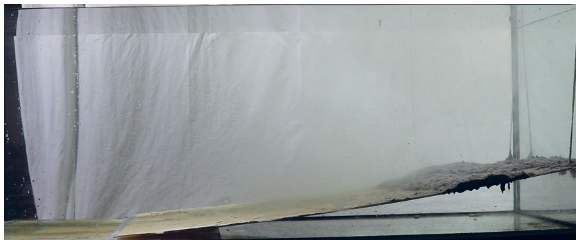
Rys. 9. Z zawiesiny o zbyt dużej koncentracji objętościowej (około 40%) nie udało wytworzyć się prądu zawieszinowego – powstały tzw. kluchy (fot. Z. Ziarek)
