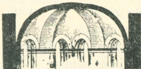
Rys. 178. Sklepienie kopankowate z kolebkami kulistemi.
