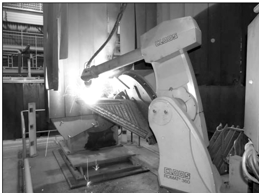
Rys. 3. Stanowisko zrobotyzowane ROMAT 360 do napawania naroży
