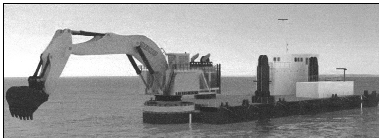
Rys. 6. Pogłębiarka wyposażona w hydrauliczną koparkę łyżkową podsiębierną o pojemności łyżki 16,5 \text{ m}^3
