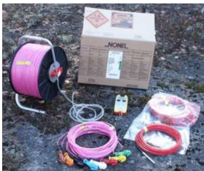
Rys. 2.12. Elementy systemu inicjacji NONEL UNIDET (Poradnik Nonel 2003)
