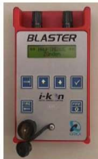
Rys. 2.15. Zapalarka Blaster 400 (Mat. Rek. Orica 2007)
