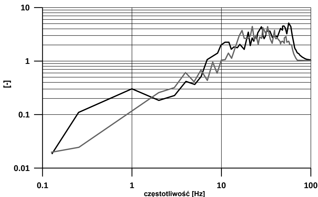
Rys. 4.32. Spektrum odpowiedzi drgań wzbudzonych ruchem drogowym dla składowych poziomych (Kogut 1999)
