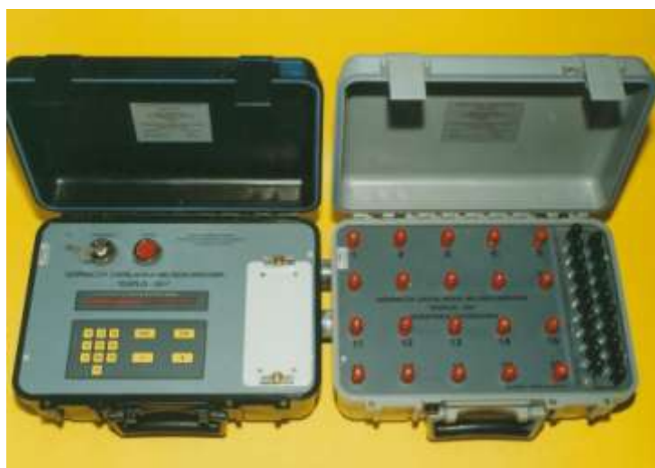
Rys. 2.11. Zapalarka milisekundowa EXPLO-201 (Biessikirski 1996)
