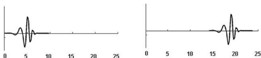
Rys. 4.10. Przykład zmiany współczynnika przesunięcia (translacji) falki
